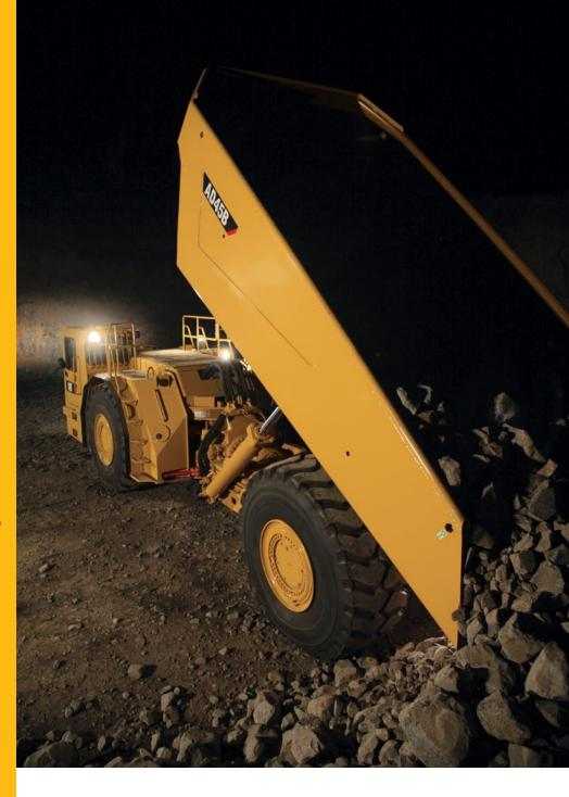
El Camión Articulado Subterráneo AD45B está diseñado para el acarreo de alta producción y bajo costo por tonelada en aplicaciones de minería subterránea. La construcción sólida y la simplificación del mantenimiento garantizan una larga vida útil con bajos costos de operación.
