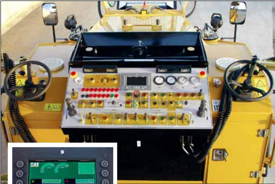
*La amplia pantalla proporciona parámetros de la operación para realizar el diagnóstico de la máquina y del motor.*
