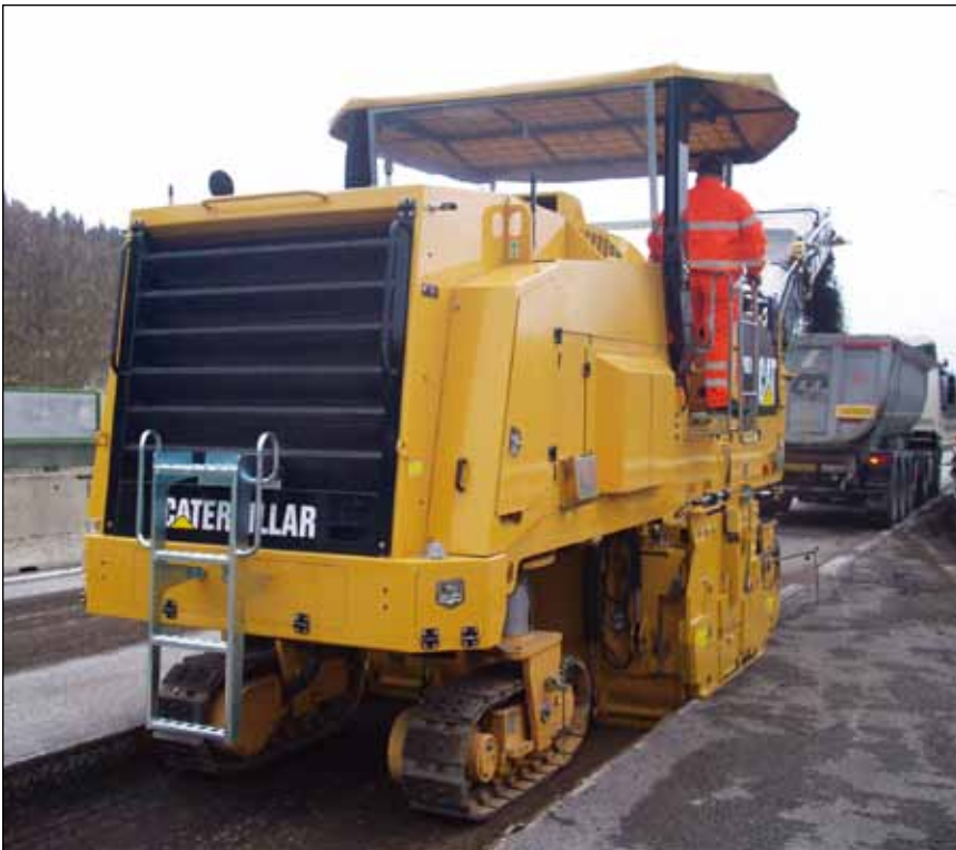
PM200 con la opción de rotor de 2,2 m (88 pulg).
