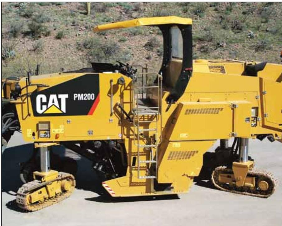
**Cuatro modalidades de dirección.** El control de dirección proporciona cuatro modalidades de dirección para maniobrar en espacios reducidos: dirección delantera, dirección acodillada, dirección coordinada y dirección trasera únicamente.
