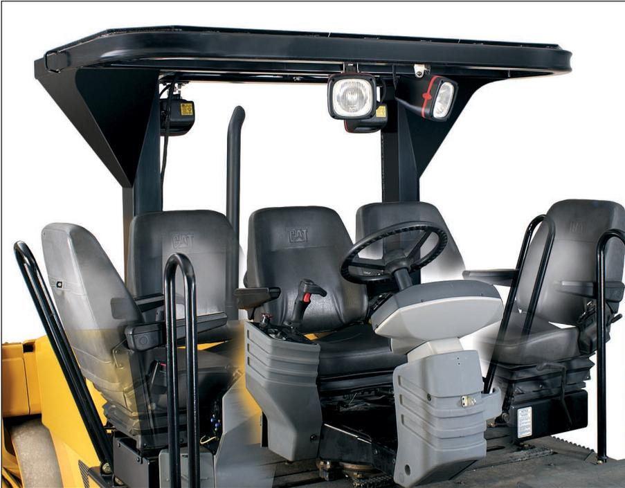
Para que la protección que proporciona la estructura FOPS sea eficaz, el operador debe estar sentado debajo del techo.
