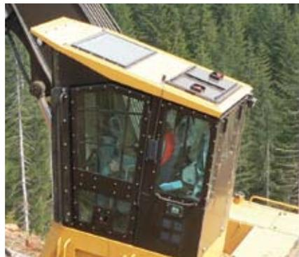
**Cabina forestal instalada de fábrica.** La cabina FOPS para aplicaciones forestales, diseñada y construida en las plantas de Caterpillar, tiene opciones de protección del parabrisas y de las ventanas para cumplir con los requisitos de protección locales. Las ventanas del lado derecho y trasera están fabricadas con policarbonato resistente a los impactos.
