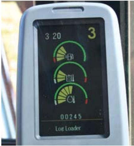
**Monitor.** El monitor es una pantalla de cristal líquido (LCD) a todo color, con una resolución de 400x234 píxeles. El ángulo del monitor puede ajustarse para minimizar el reflejo del sol, y puede mostrar la información en 27 idiomas diferentes.
