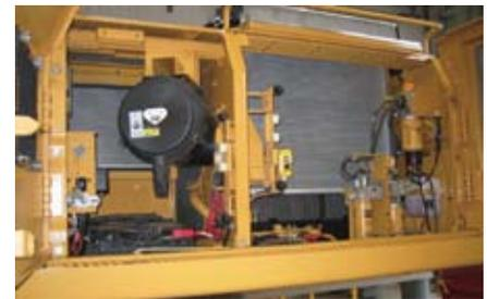
**Puertas de acceso de servicio pesado.** Las puertas de acceso de servicio pesado son parte del equipo estándar en las Máquinas Forestales 320D FM y se fabrican de acero de baja aleación y alta resistencia de 6 mm (0,24 pulg). El pestillo de traba firme permanece cerrado en aplicaciones forestales. Las bisagras tienen pasadores de mayor diámetro en puertas estándar. El perfil liso de la puerta mejora la apariencia de la máquina.
