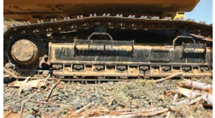
**Rodillos superiores de servicio pesado.** Los rodillos inferiores con soportes dobles reemplazan los rodillos superiores para proporcionar mayor resistencia.
