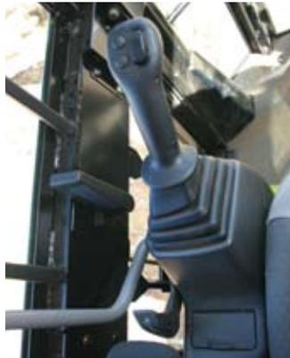
controles de palanca universal requieren un esfuerzo mínimo y están diseñados para adaptarse a la posición natural del brazo y de la muñeca del operador. Estos controles se pueden operar con un brazo en el posabrazos, y el movimiento vertical y horizontal está diseñado para reducir la fatiga del operador. El control proporcional exclusivo y los botones se pueden programar de acuerdo a las preferencias personales del operador, permitiendo la máxima productividad.
