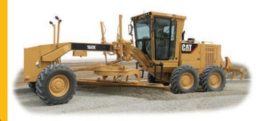
La 160K optimise votre investissement en offrant une productivité et une longévité maximales. Le moteur Cat C7, la boîte de vitesse commandée en charge (powershift) et le circuit hydraulique sensible à la charge fournissent ensemble à la machine une puissance et une précision qui permettent de travailler dans les meilleures conditions.
