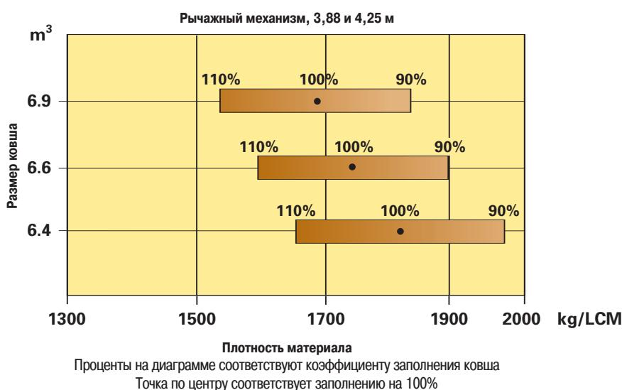
Номинальная грузоподъемность зависит от массы ковша, включая массу установленной на месте эксплуатации оснастки. За консультациями по подбору и комплектованию ковша для тех или иных рабочих условий следует обращаться к дилеру Caterpillar. Компанией Caterpillar разработаны указания по определению полезной нагрузки тяжелых автопогрузчиков. Их задача – максимально увеличить срок службы компонентов и силовых элементов машины.
