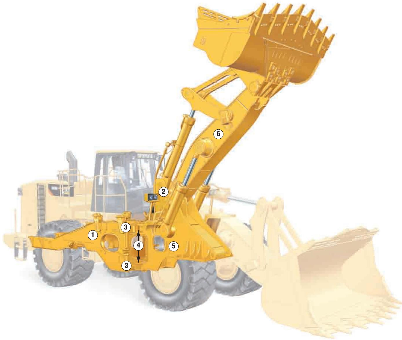
**Силовые элементы конструкции.** Силовые элементы конструкции изготовлены методом роботизированной сварки. В местах наибольших напряжений использованы литые детали. Более 90% силовых элементов погрузчика 988Н сварено роботизированным оборудованием. Этим обеспечивается высокая однородность сварного шва и его повышенная прочность. В нескольких местах для увеличения прочности, распределения нагрузок и уменьшения числа конструктивных элементов использованы литые детали.
