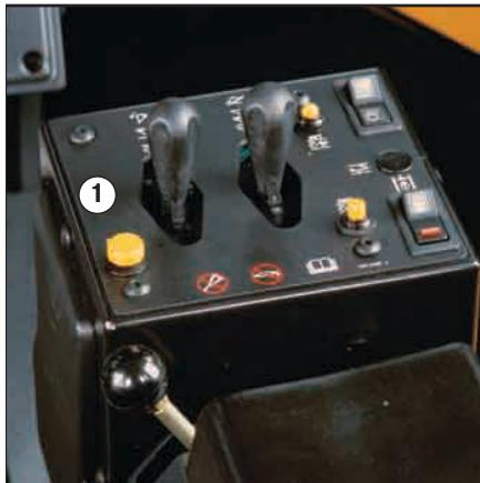
**1 Электрогидравлическая система управления.** Электрогидравлическое управление увеличивает эффективность гидросистемы, а благодаря органам управления, не требующим больших усилий, оператор меньше утомляется. Применение шлангов XT-3 и XT-5 и надежных фитингов снижает вероятность утечек и разрывов трубопроводов и делает машину более экологичной.
