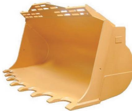
**锯齿刃式煤用铲斗。**锯齿刃式铲斗推荐用于需要更大穿透力的低磨蚀物料的装载。它不使用掘地工具，从而消除了铁块掉入破碎机的风险。如有必要，可提供可更换式锯齿式或直边式铲刃。锯齿式铲刃是 36 m<sup>3</sup> (47 yd<sup>3</sup>) 煤用铲斗的标准配置，但如有要求，也可加装到小型的铲斗上。
