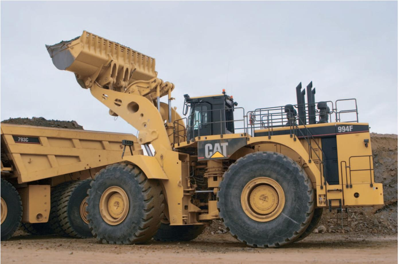
**液压系统。**完全封闭式的液压系统，采用独立的提升、倾斜、转向和制动控制回路。独立的回路可以提升冷却能力，防止交叉污染，从而减少停机维修时间，提高生产率。
