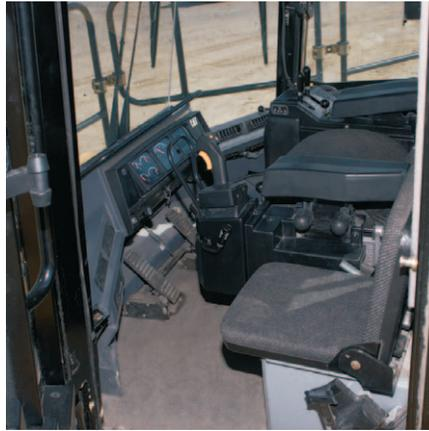
**教练座椅。**教练座椅包括一个带衬垫的座椅和带安全腰带的靠背。教练座椅不使用时可向下折叠，当成一个饮料架；在座椅下面有一个储物格（适于放置午餐盒的较大空间）。
