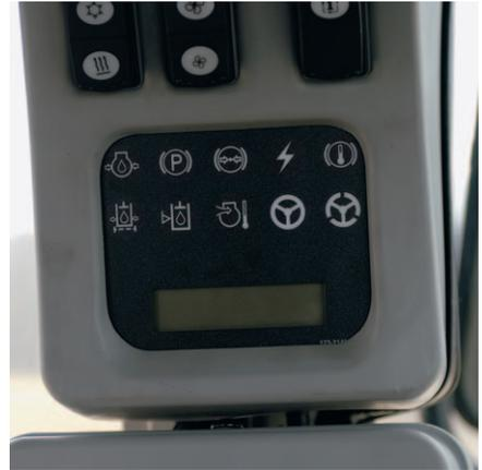
**卡特彼勒监控系统。**950H 配备卡特彼勒监控系统 (CMS)，可以始终监控您的装载机状况。CMS 监控重要的发动机系统功能，并将在必要时使发动机减额以避免损坏。根据所出现的以下六项紧急状况，CMS 监控器或前面板将点亮警告灯并发出声音警报。
