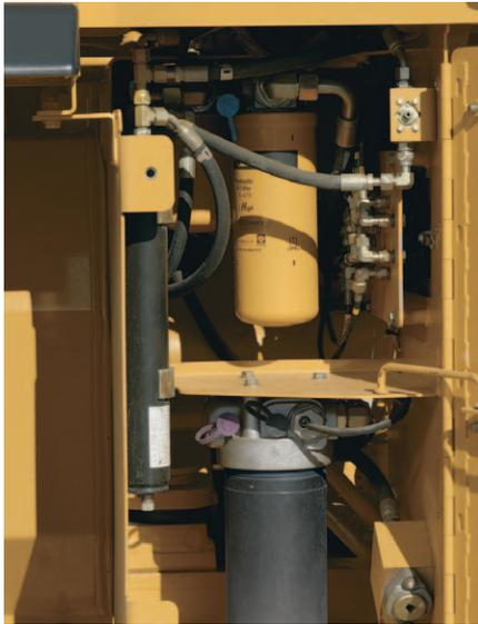
**液压装置维修中心。**变速箱油和液压滤清器位于装有铰链的右侧上下梯子后方的液压装置维修中心内。可使用检修口从此处将液压油箱排空。
