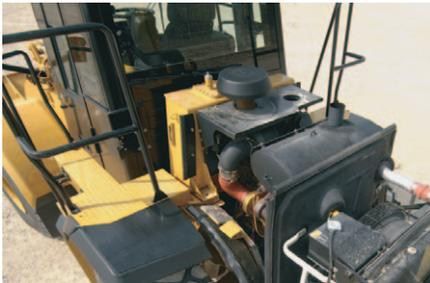
**发动机室通道。** 950H 上的非金属发动机罩对先前机型加以重新设计和改良。由于采用了更加坚固耐用的强化支撑条，侧面和顶部的面板更加坚固 — 轮廓的改变也增加了发动机罩的刚性。
