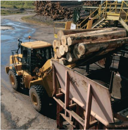
**载荷传感液压系统。**950H 采用载荷传感液压系统，可自动调节操作条件，并仅提供机具需要的液压流量，燃油效率显著提高。
