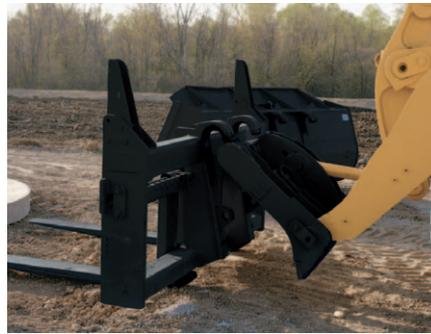
**快速连接器。**快速连接器提供无与伦比的多功能性。液压模式使操作员在几秒之内无需离开驾驶室就可更换附件。在手动模式下操作员必须锁住活塞销。
