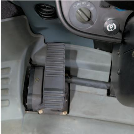
**整体式制动系统。**卡特彼勒专有的整体式制动系统，可降低轮轴的机油温度，提高变速箱平衡器的平稳性。IBS 对轮轴和制动器的耐久性有直接影响，尤其是涉及长距离和/或重型制动时。
