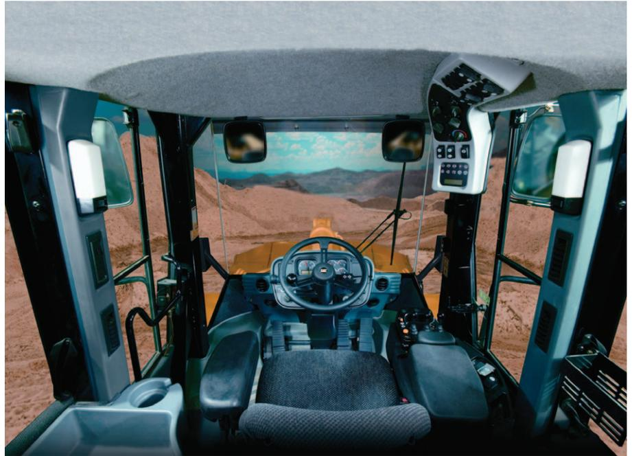
**指令控制转向。**指令控制转向是载荷感应系统，它与方向盘和机架角度位置相连以提供正确的转向操纵感，使操作员尽可能地省力。机器的转弯速度与方向盘的位置成正比。在任何条件下，操作员只需不到 6 lb (26 N) 转向力即可转向。机器完全转向方向盘打把  $\pm 70^\circ$ ，而传统方向盘需要打把两至三个圈。
