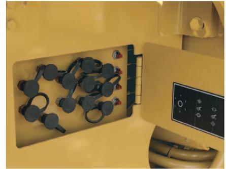
**远距离测压口。**转向和液压系统的测压口，变速箱（可选配）和制动器在右侧维修平台正下方、工作面板的后面。
