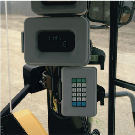
**有效载荷控制系统。**专为卡特彼勒机器设计的计量设备，可在装载的同时称出铲斗内材料的重量。操作员可以更准确更有效地装载卡车。一次性准确装载卡车相当于加快了操作周期，提高了操作的生产率和可控性。
