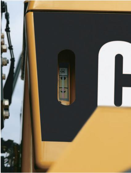
**检视计。** 保护良好、便于查看的检视计用于变速箱、液压油和散热器冷却液，方便日常检查，同时降低了杂质进入系统的风险。
