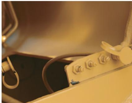
**地面润滑点。**黄油嘴集中设置在机器右侧的两个方便的位置 – 右侧维修平台下方的维修室内，以及非发动机后架旁的润滑脂罐。这些位置便于润滑整个机器上的主要部件。
