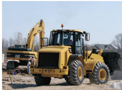
**发动机怠速管理系统。**发动机怠速管理系统 (EIMS) 可以使燃油效率最大化，并可以根据特殊的作业需求灵活管理怠速。可提供四种怠速控制转速。
