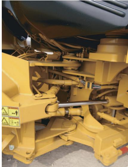
**伸展铰接件。**上下铰接盘之间的距离对机器性能和部件寿命有重要影响。卡特彼勒的伸展铰接件设计提供卓越的载荷分布和连杆轴承寿命。上下铰接销枢轴均安装在双锥形滚子轴承上，增大了垂直和水平载荷的分布面积，使耐久性得以显著提升。宽敞的维修入口非常方便检修。
