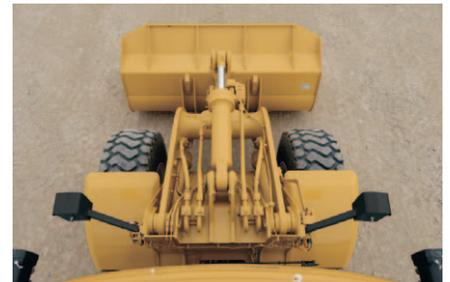
**连杆机构。**950H 连杆机构设计为单倾斜 Z 形连杆。Z 形连杆实现出色的插入力和理想的机架后倾角度，使铲斗装载与载荷保持效果更佳。
