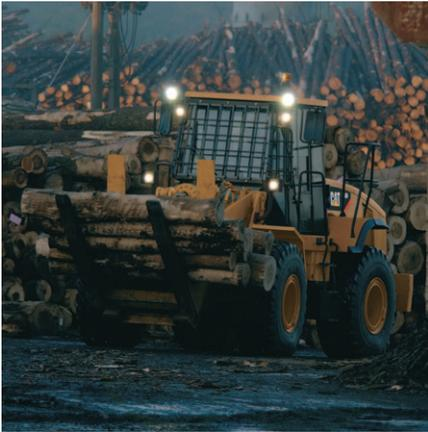
**林业作业。**林业机械配置总成提供适用于林业和采伐业的行驶控制、重型倾斜油缸和附加配重。为林业应用特别设计的作业机具可由工厂安装。
