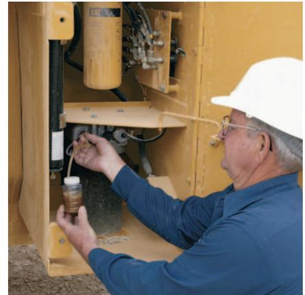
**S•O•S服务。**在 950H 上的取样阀可快速地接触到发动机、变速箱和液压油以进行S•O•S分析。机油更换间隔和其他维修可根据您的工作时间表进行优化，以减少停机时间并管理开支。
