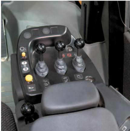
**座椅。**卡特彼勒 C-500 系列空气悬浮舒适座椅为 950H 的标准配备，其设计制造坚固耐用，可沿 6 个方向调节，各种身材的操作员均可最舒适就座。整体式注塑的椅背和座位可防止座垫伸出。座椅具有汽车式样的腰部支持，以提供最大的舒适度。可以使用整体机具控制调节右侧座位扶手的舒适程度，操作方便。选配的加热座椅为您带来意外惊喜。
