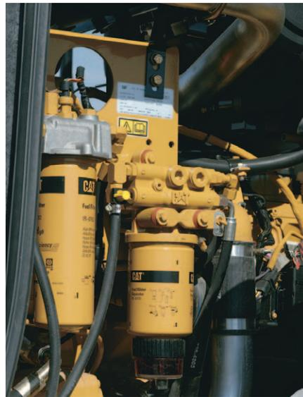
**电动充油泵。** 位于主燃油滤清器底座上的电动充油泵使操作员在更换后不必预先充油或手动灌装滤清器，避免了发动机污染。
