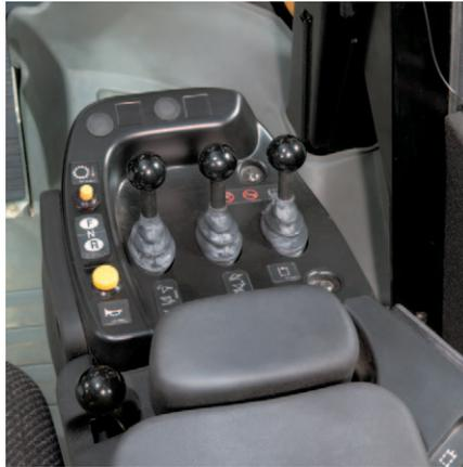
**电子液压机具控制装置。**950H 的电子液压机具控制装置使操作员可在驾驶室内对自动停用进行程序控制，以防止材料溢出，从而提高了生产率。机具控制台上装有可选的前进/空挡/后退开关，可以快速方便地改变方向，以降低周期时间。
