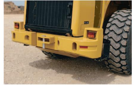
**配重。**950H 的设计和外观选用了整体式配重。这种 1853 lb (840 kg) 的配重将尾灯放在结构顶部。
