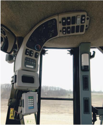
**控制装置。**950H 上的主控面板位于右侧 ROPS 位置的上方 — 操作员伸手即可触及，同时不影响地面视野。所有开关和控件都放在方便的位置，有利于提高效率，改进生产率，同时尽量降低操作员疲劳度。
