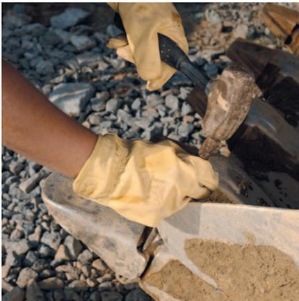
**掘地工具 (GET)。**卡特彼勒为 950H 铲斗提供多种掘地工具选择。铲斗的设计采用了铸造边角齿根，使斗齿可以放在最靠边的位置，以防止铲斗底座磨损。
