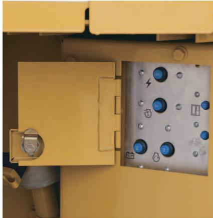
**电气维修中心。**蓄电池、继电器面板和选配的工具箱位于左侧维护平台的下方，操作方便。发动机熄火开关安装在继电器面板内。集成到工作平台内的腔室包含发动机罩倾斜驱动开关、主控开关和选配的跨接起动插座。
