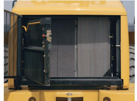
**冷却系统。** 用来进行清理和维护的冷却系统通道非常方便。穿孔和波纹状的支架减少了杂物的堆积，外摆式结构方便清洁和拿取冷却芯件。
