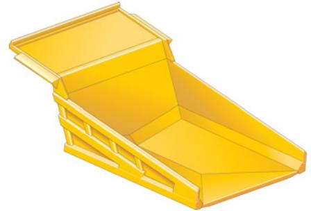
**Bak Dual-Slope.** Desain bak dual-slope yang canggih dengan lantai berbentuk “V” meningkatkan kemampuan penahanan muatan, mempertahankan pusat gravitasi yang rendah, mengurangi beban kejut, dan mempertahankan distribusi beban yang optimal pada tanjakan yang curam dan pada kondisi jalan angkut yang berat.
