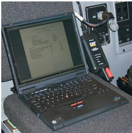
**Electronic Technician (ET).** Peralatan servis Cat ET menyediakan akses yang mudah bagi teknisi servis ke data diagnostik yang tersimpan melalui Cat Data Link guna menyederhanakan diagnosa permasalahan dan meningkatkan kesiapan alat berat.
