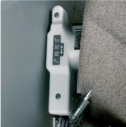
**14) Tuas Hoist.** Sistem hoist elektronik empat posisi dengan kontrol sentuh menyediakan peredaman bak turun dengan dampak rendah. Terpasang di dekat kursi operator untuk memudahkan pengoperasian.
