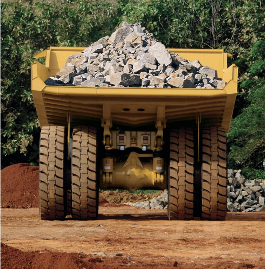
**Integrated Braking System.** Sistem pengereman didinginkan oli dari Cat menghasilkan kinerja yang handal dan kendali dalam kondisi jalan angkut yang paling ekstrim. Sistem yang terintegrasi menggabungkan rem servis, sekunder dan parkir serta fungsi perlambatan dalam sebuah sistem yang sama dan kokoh guna menghasilkan efisiensi pengereman yang optimal.
