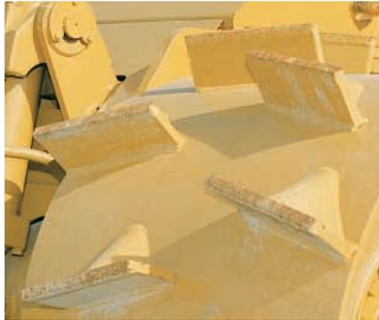
**Ruedas cortadoras de limpieza automática.** Las ruedas cortadoras de limpieza automática están diseñadas para proporcionar compactación y tracción máximas. La acción de corte potente es proporcionada por 20 hojas por rueda. Las hojas de acero ARM DH-2™ termotratado, proporcionan mayor vida útil.
