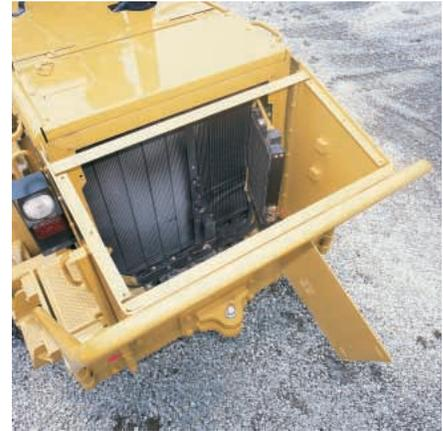
**Núcleo de aceite hidráulico abatible hacia afuera.** Permite una fácil limpieza e inspección sin herramientas.
