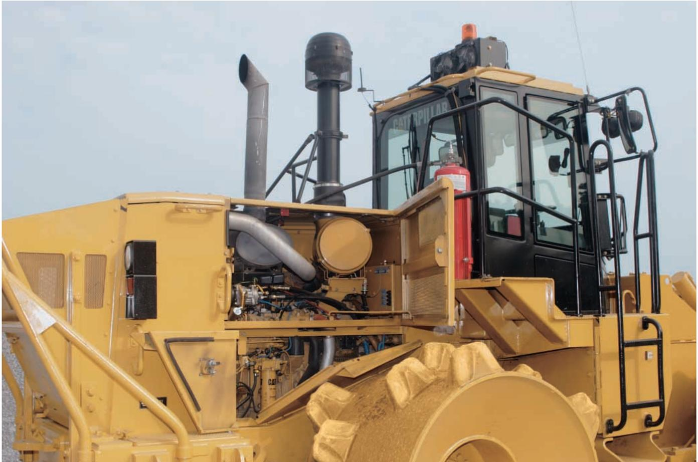
**Acceso al motor.** Las puertas metálicas abisagradas de acceso al motor facilitan el mantenimiento y las inspecciones diarias.
