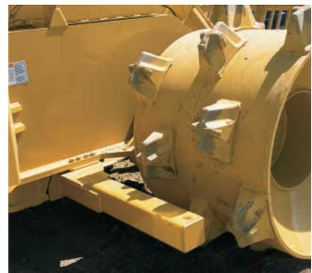
**Barras deflectoras.** Ubicadas delante y detrás de las ruedas traseras y detrás de las ruedas delanteras, proporcionan gran protección contra basura arrojada o transportada por las ruedas.
