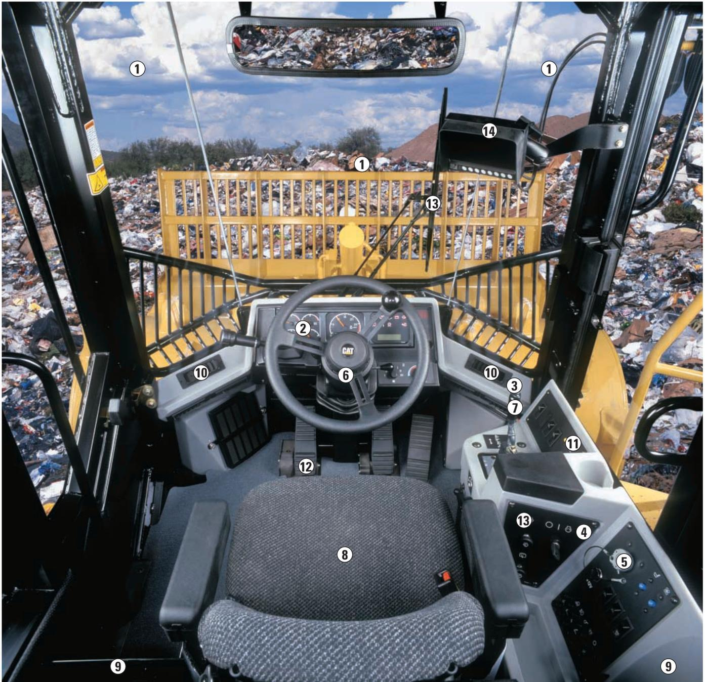
**1 Área de visión excepcional alrededor de la máquina.** La mayor área de visión reduce la tensión y la fatiga, haciendo que los operadores sean más productivos. Con el accesorio de cámara de visión trasera, el operador puede ver más fácilmente el área detrás de la máquina a través de un monitor instalado en la cabina.
