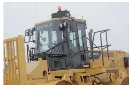
**Condensador de aire acondicionado de instalación en techo.** El condensador de aire acondicionado abisagrado se abre mediante giro y se acopla con el enfriador de aceite hidráulico, lo que permite la limpieza fácil y rápida del sistema de enfriamiento.
