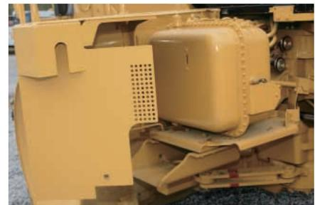
**Tanque hidráulico y cilindros de dirección.** Los cilindros están protegidos para resistir daños y el tanque tiene una estructura de protección.
