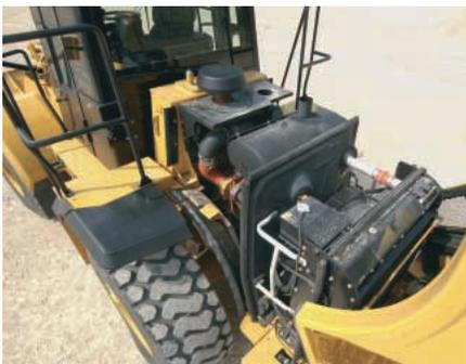
**ACCESO DEL COMPARTIMIENTO DEL MOTOR.** El capó no metálico del 962H se ha cambiado de diseño y estilo con respecto a modelos previos. Los paneles laterales y superior son más fuertes debido a unas nervaduras de refuerzo más robustas – el cambio de contorno también aumenta la rigidez del capó.
