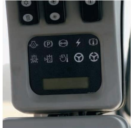
**Sistema Monitor Caterpillar.** El 962H está equipado con el Sistema Monitor Cat (CMS) que vigila el estado de su cargador. El CMS supervisa las funciones críticas del motor y disminuirá la potencia del motor para protegerlo contra los daños si es necesario. Dependiendo de cuál de las seis condiciones siguientes surja, el monitor del CMS o el tablero delantero mostrarán luces de advertencia y alarmas audibles.
