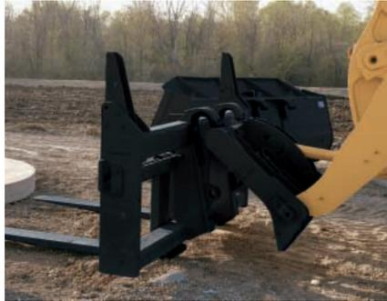
**Acoplamientos rápidos.** Los acopladores rápidos confieren una versatilidad sin paralelo para los cargadores de ruedas. El modelo hidráulico permite a un operador cambiar accesorios en unos segundos sin salir de la cabina. En el modelo manual, el operador debe trabar los pasadores.
