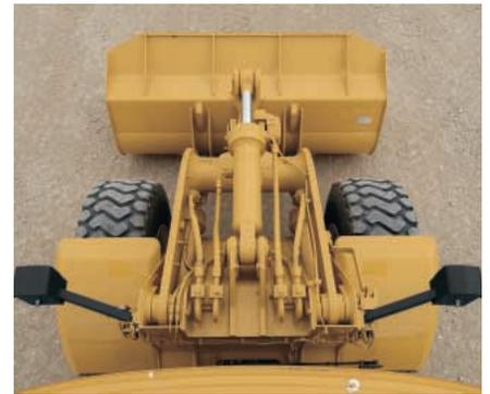
**Varillaje.** El varillaje del 962H tiene un diseño de barra en Z de una sola inclinación horizontal. El varillaje de la barra en Z genera una fuerza de desprendimiento excelente y tiene un buen ángulo de inclinación hacia atrás para cargar mejor el cucharón y retener mejor la carga.
