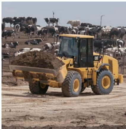
**SERVOTRANSMISIÓN.** El 962H sigue usando una tecnología de servotransmisión de funcionamiento demostrado en modelos anteriores y se usa actualmente hasta en el cargador de ruedas más grande fabricado por Caterpillar – el 994F.
