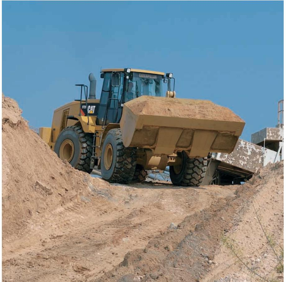
**Herramientas de corte.** Caterpillar dispone de varias opciones de herramientas de corte para los cucharones del 972H. Se ha incorporado un adaptador de esquina hecho de fundición en el diseño de los cucharones que permite colocar un diente en la esquina del extremo para proteger contra el desgaste de la base del cucharón.
