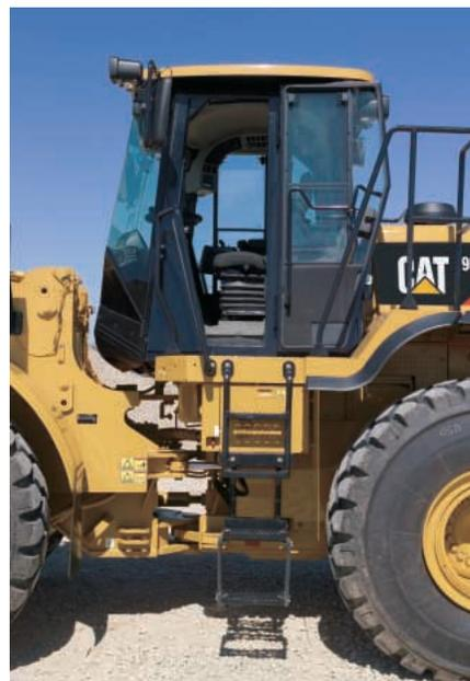
**ENTRADA Y SALIDA.** Escalera con escalones de autolimpieza que mantiene la acumulación de escombros al mínimo. La escalera está inclinada 5° hacia adelante para facilitar la entrada y la salida.
