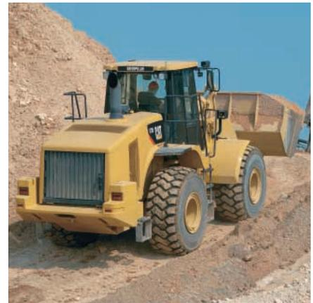
**CONTROL DE AMORTIGUACIÓN.** El sistema de control de amortiguación optativo mejora la amortiguación, el rendimiento y la retención de carga cuando se desplaza sobre terreno irregular. Los operadores toman confianza desplazándose a mayores velocidades en las operaciones de carga y transporte disminuyendo los tiempos de los ciclos y aumentando la productividad.
