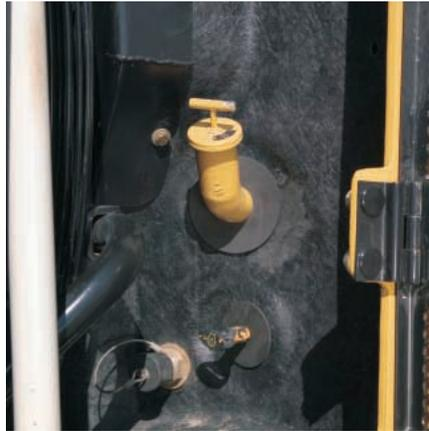
Con el capó cerrado, los cambios rápidos de los niveles de aceite del motor y la mirilla del refrigerante puede completarse a través de las puertas de servicio laterales.
