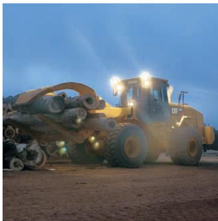
**Conjuntos de iluminación.** Se dispone de conjuntos de iluminación optativos para aplicaciones de desplazamiento por carretera o luces bajas. Las luces optativas de Descarga de Alta Densidad (HID) proporcionan una iluminación excepcional para el trabajo nocturno. Se dispone de una baliza giratoria como característica de seguridad.
