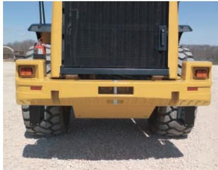
**Contrapeso.** El contrapeso de una pieza está integrado en el diseño y el estilo del 972H. Este contrapeso de 5.849 lb (2.653 kg) incorpora las luces traseras en la parte superior de la estructura.
