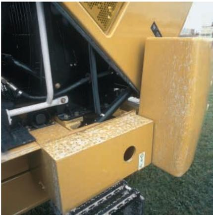
Dispone de un solo cilindro de levantamiento mecánico con retroceso manual que abre el capó. El capó inclinable permite un acceso excelente al compartimiento del motor, y si es necesario, todo el capó puede retirarse con los puntos de levantamiento integrados.
