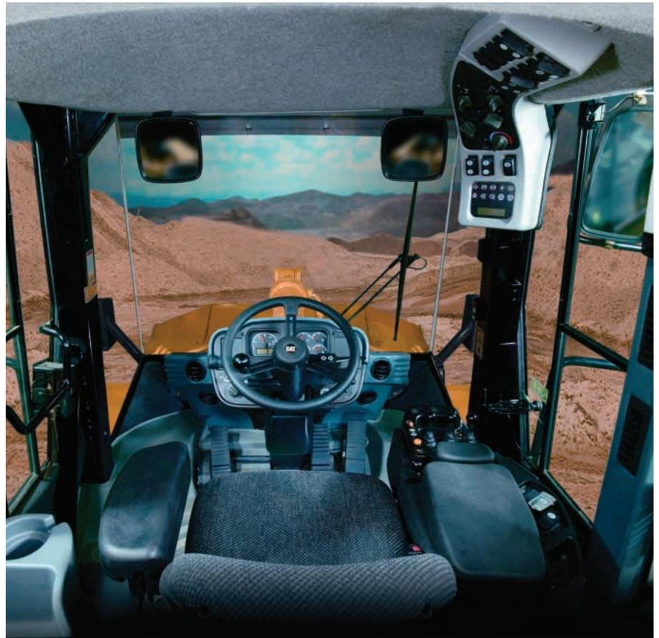
El volante Command Control contiene el interruptor de avance/neutral/retroceso y el botón de cambios ascendentes/descendentes – permitiendo que la mano izquierda permanezca en el volante en todo momento. Los controles del accesorio están integrados en el apoyabrazos derecho de modo que se mueven con el operador.
