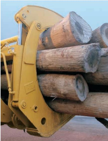
**Horquillas.** Se dispone de horquillas de paletas, para troncos y aserraderos para aplicaciones forestales y manipulación de materiales.
