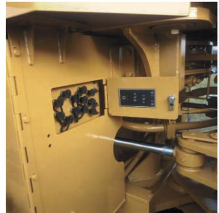
**TOMAS DE PRESIÓN REMOTAS.** Las tomas de presión para los sistemas de la dirección e hidráulico, transmisión (optativo) y frenos están agrupados detrás de un panel de acceso justo debajo de la plataforma de servicio del lado derecho.
