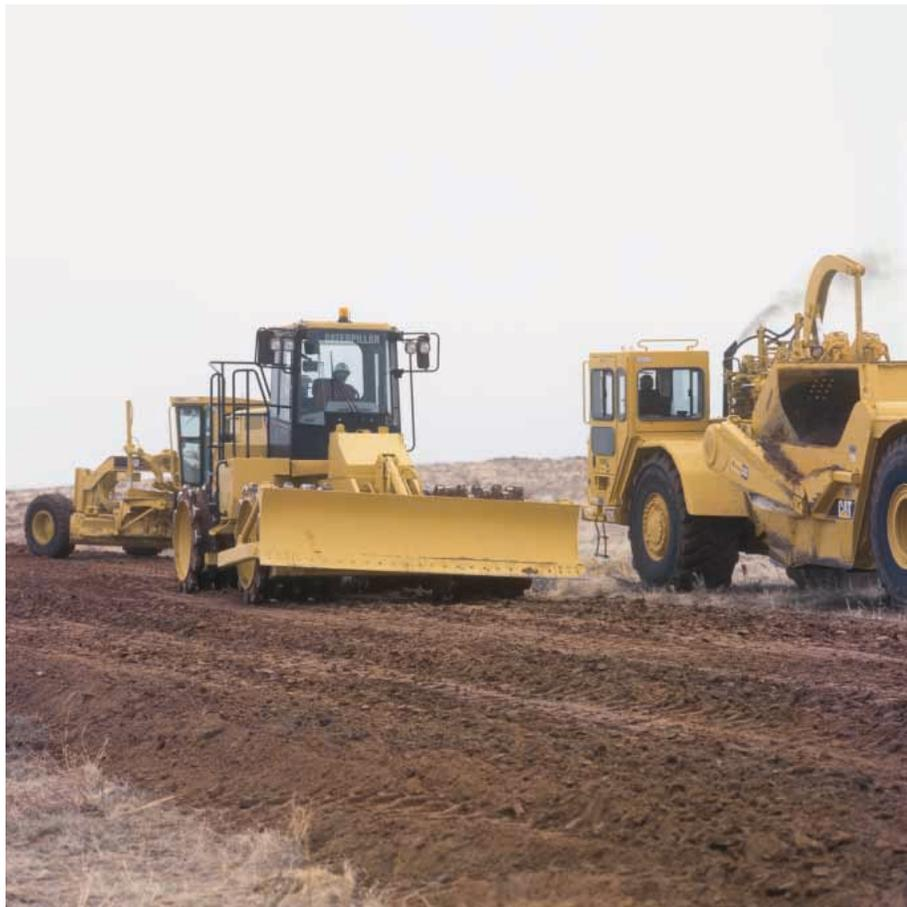
**Paquete de la hoja.** Consta de la hoja, brazos de empuje, soporte del muñón, plancha de patinaje de longitud de la hoja topadora con planchas de desgaste reemplazables, cuchillas reversibles, cantoneras de autoafilado, protectores de la tubería hidráulica y cilindros de levantamiento hidráulico.
