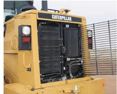
**Enfriador de aceite hidráulico abisagrado.** Se abren girándolos, sin usar herramientas especiales.
