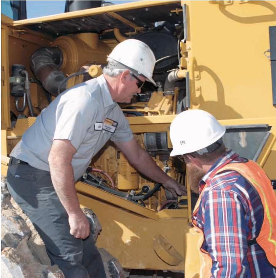
**Acceso al motor.** Las puertas metálicas abisagradas de acceso al motor facilitan el mantenimiento y las inspecciones diarias.
