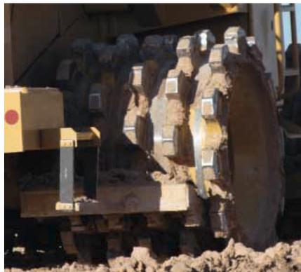
**Barras limpiadoras.** Ayudan a mantener los tambores libres de suciedad, independiente de la dirección de rodadura. Un diseño de perno de paso completo facilita el servicio.
