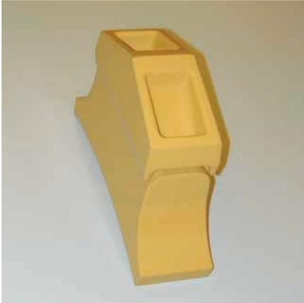
**Patrón simétrico de las puntas de la rueda con pisonos.** Es un diseño modificado de la punta de sardineta de la rueda con pisonos, que proporciona mayor presión sobre el suelo, mayor compactación, un desplazamiento más suave y excelente tracción. La altura de la punta es 190 mm (7,5 pulg) y el ancho es 168 mm (6,6 pulg).
