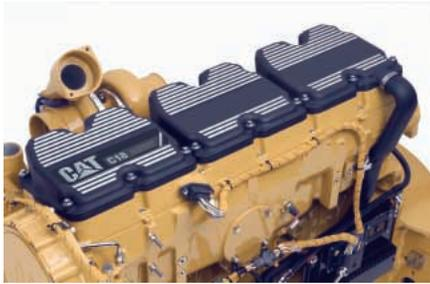
**Motor diesel.** El C18 de Caterpillar con tecnología ACERT es un motor de 18,1 litros, seis cilindros, de 382 kW (513 hp) con inyección electrónica de combustible mecánicamente accionada (MEUI) y árbol de levas en culata. La tecnología ACERT provee rendimiento sobresaliente del motor mediante el control electrónico avanzado, entrega precisa de combustible, y administración perfeccionada de aire.
