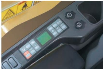
**Consolas.** Consolas que disponen de un nuevo diseño sencillo y funcional para reducir la fatiga del operador, facilitar la operación del interruptor y una visibilidad excelente. Ambas consolas tienen posabrazos fijados que permiten que se ajuste la altura de los posabrazos.
