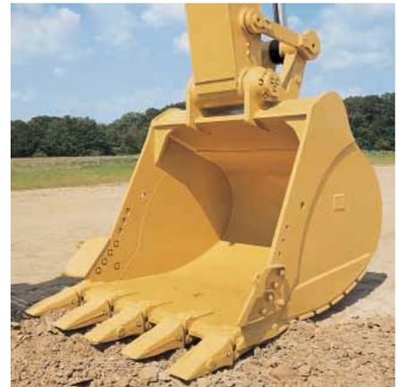
**Herramientas de corte.** Las herramientas de corte Caterpillar incluyen una variedad de orejetas, protectores de barra lateral, opciones de punta para adaptarse a las condiciones de operación.
