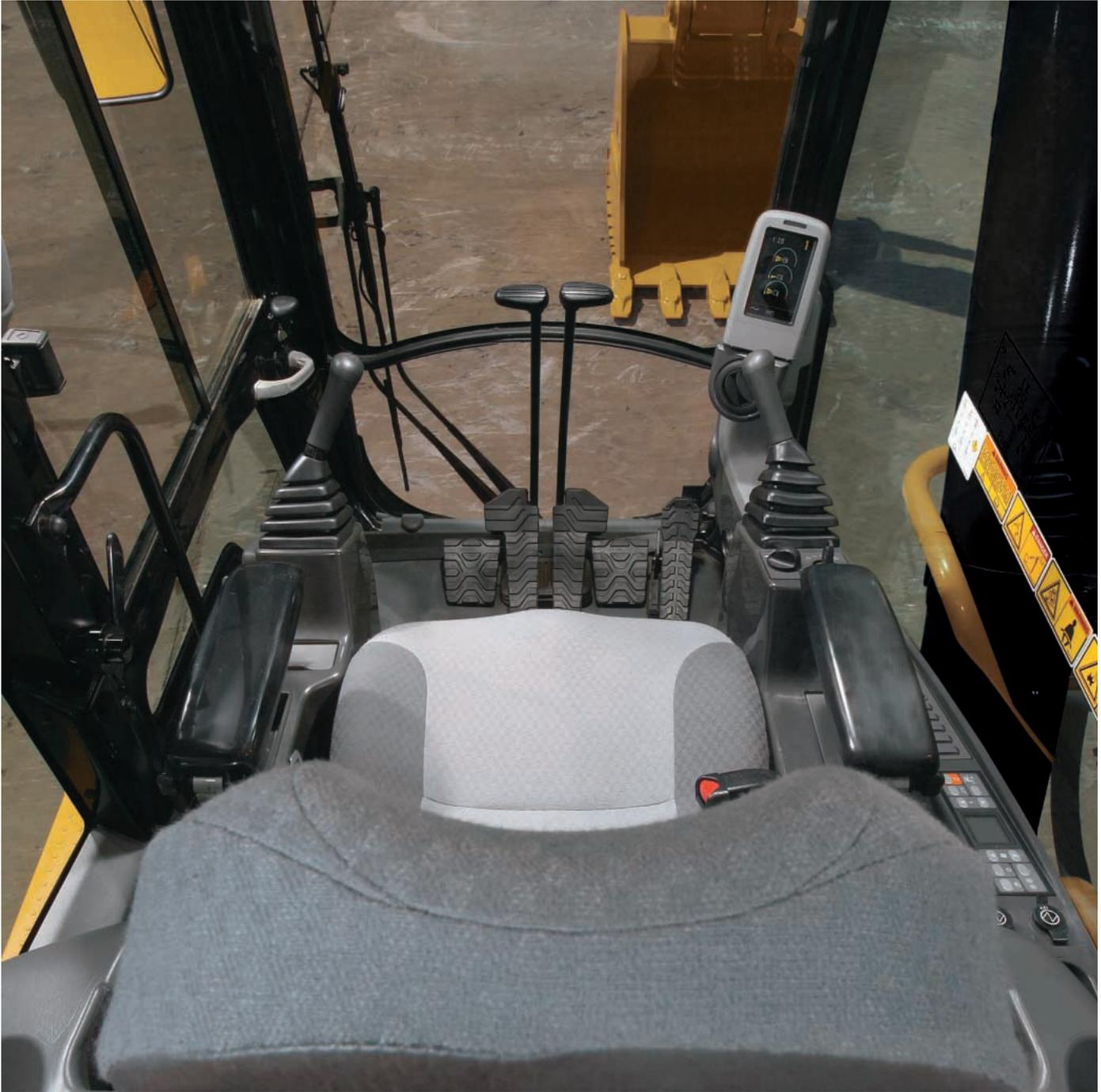
**Diseño de la cabina.** El amplio puesto de trabajo ha sido diseñado para que el operador trabaje con poco ruido y comodidad. La comodidad del operador y un alto nivel de visibilidad aseguran buena productividad durante toda la jornada. El monitor y los interruptores están ubicados en lugares de fácil acceso y buena visibilidad.
