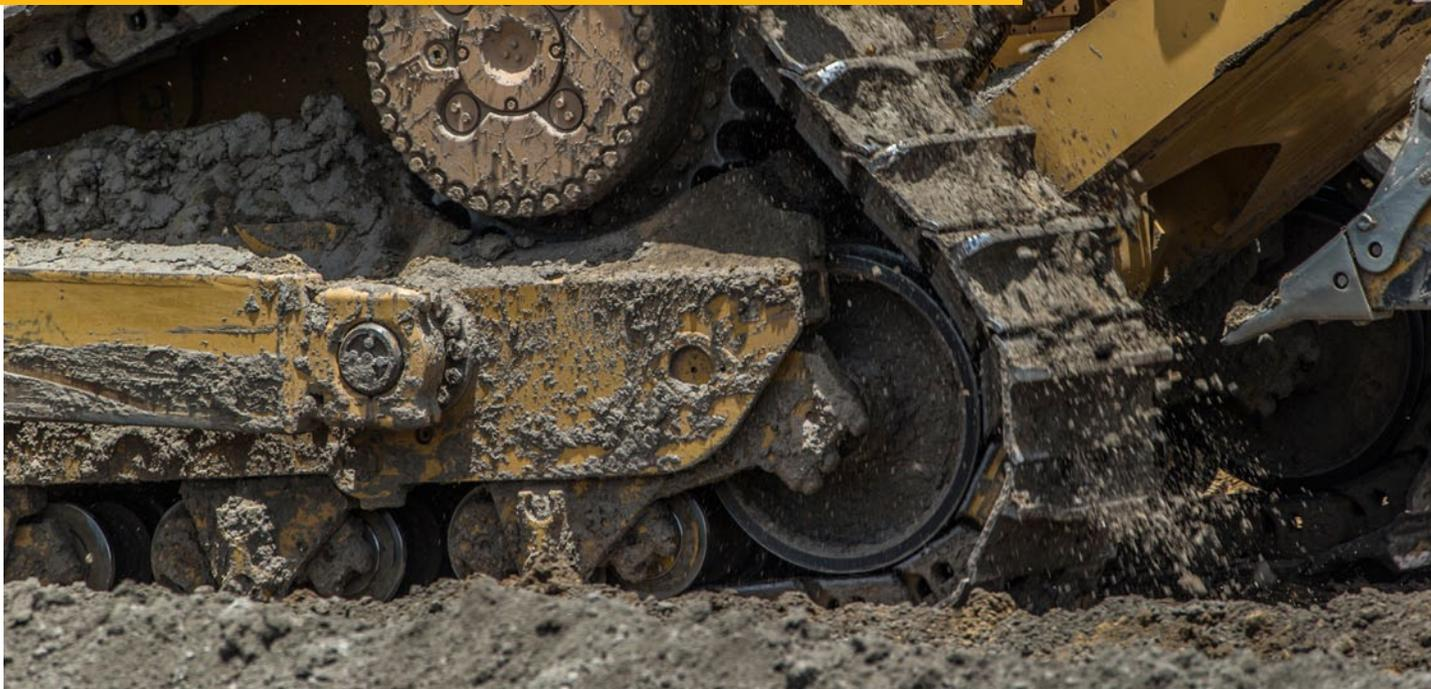
La roue d'entraînement surélevée et le train de roulement suspendu fonctionnent de pair pour améliorer la traction tout en optimisant le confort de conduite. Cette conception transfère les chocs au châssis ; les réducteurs, les essieux et les composants de la direction étant ainsi à l'abri des chocs violents. Ces avantages contribuent à augmenter la production et la durée de vie des composants.
