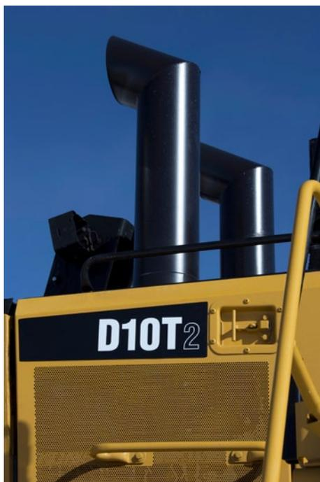
D10T2 поставляется с двумя вариантами двигателя C27 с технологией ACERT. Один из них обеспечивает соответствие требованиям стандартов Tier 4 Final на выбросы загрязняющих веществ и является единственной опцией для стран с высокими экологическими требованиями. Второй вариант сможет обеспечить соответствие требованиям стандартов, эквивалентных Tier 2 и Stage II на выбросы загрязняющих веществ, это основной вариант для стран с менее жесткими экологическими требованиями.
