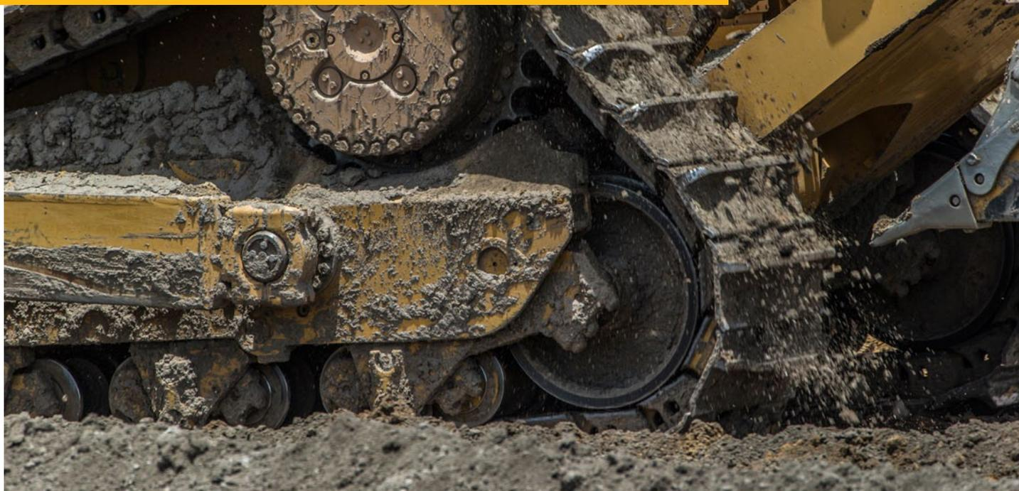
Приподнятые ведущие звездочки и подрессоренная ходовая часть обеспечивают увеличенное тяговое усилие и плавность хода машины. Эта конструкция передает ударные нагрузки от рабочего оборудования на главную раму. За счет этого обеспечивается защита бортовых редукторов, мостов и компонентов системы рулевого управления от сильных ударов. Эти преимущества гарантируют повышенную производительность и увеличенный срок службы компонентов.
