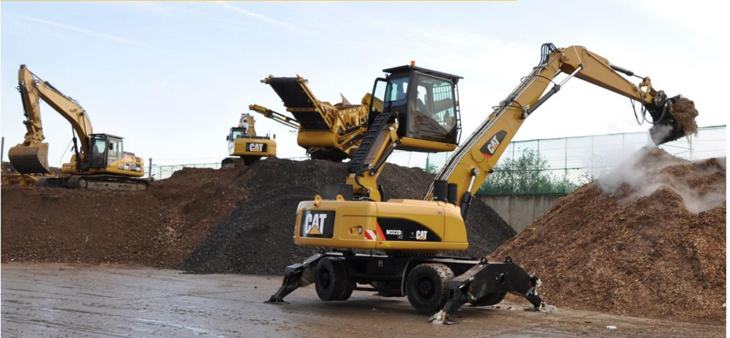
如您所知，只有物料搬运机的前连杆能够处理作业，物料搬运机才能出色地完成工作。M322D2 MH 的动臂和斗杆专为物料搬运场合中遇到的负载而制造。斗杆专门设计了前导侧板，可以最大程度地保护液压管路。
