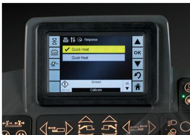
**Choix entre chauffage silencieux ou rapide facilité via l'écran LCD. Le chauffage rapide permet un gain de temps en cas d'utilisation des rallonges grande largeur.**
