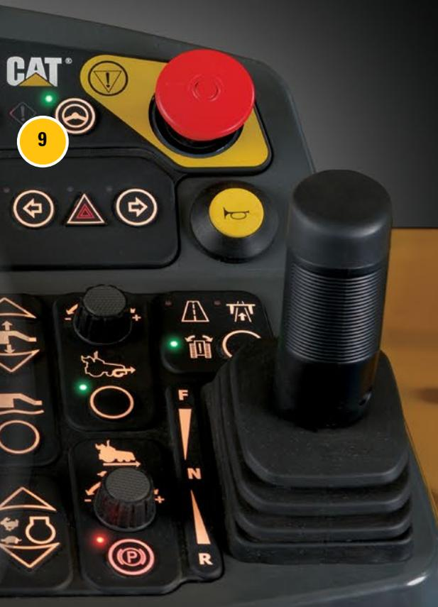
L'AP655F à chaîne en acier utilise un cadran à la place du volant standard.
