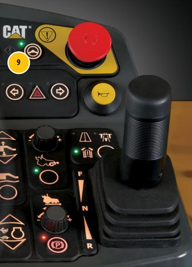
*В модели AP655F со стальной гусеничной лентой используется переключатель вместо стандартного рулевого колеса.*
