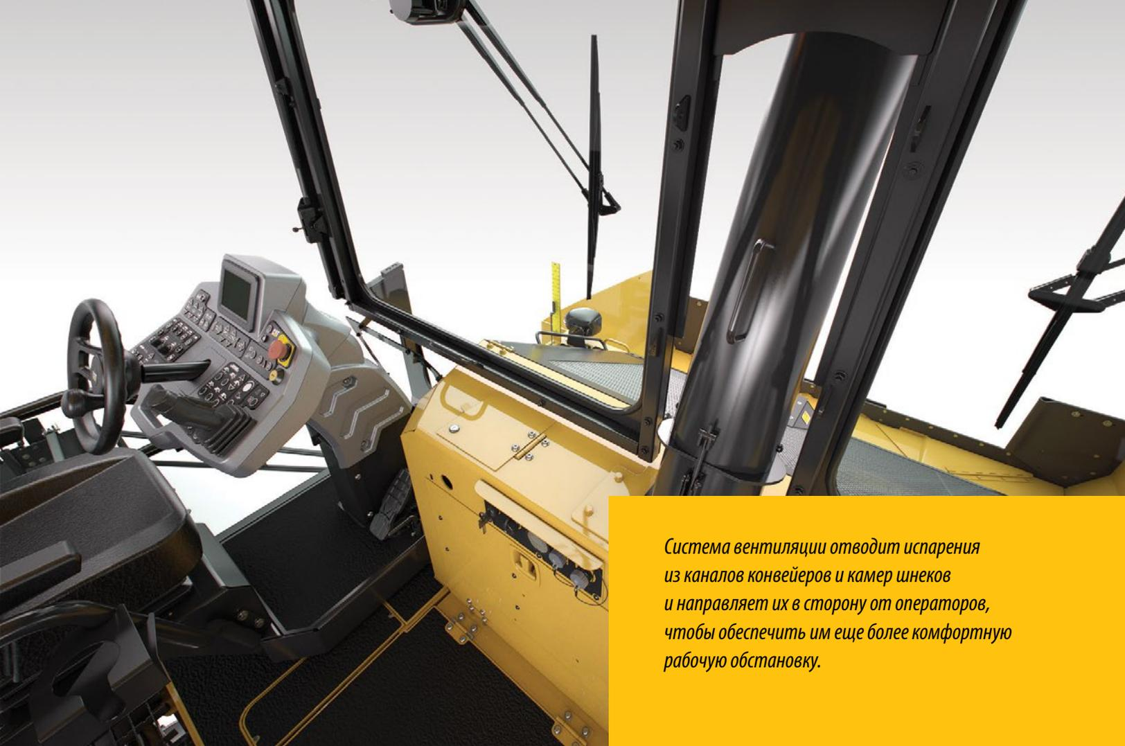
*Система вентиляции отводит испарения из каналов конвейеров и камер шнеков и направляет их в сторону от операторов, чтобы обеспечить им еще более комфортную рабочую обстановку.*
