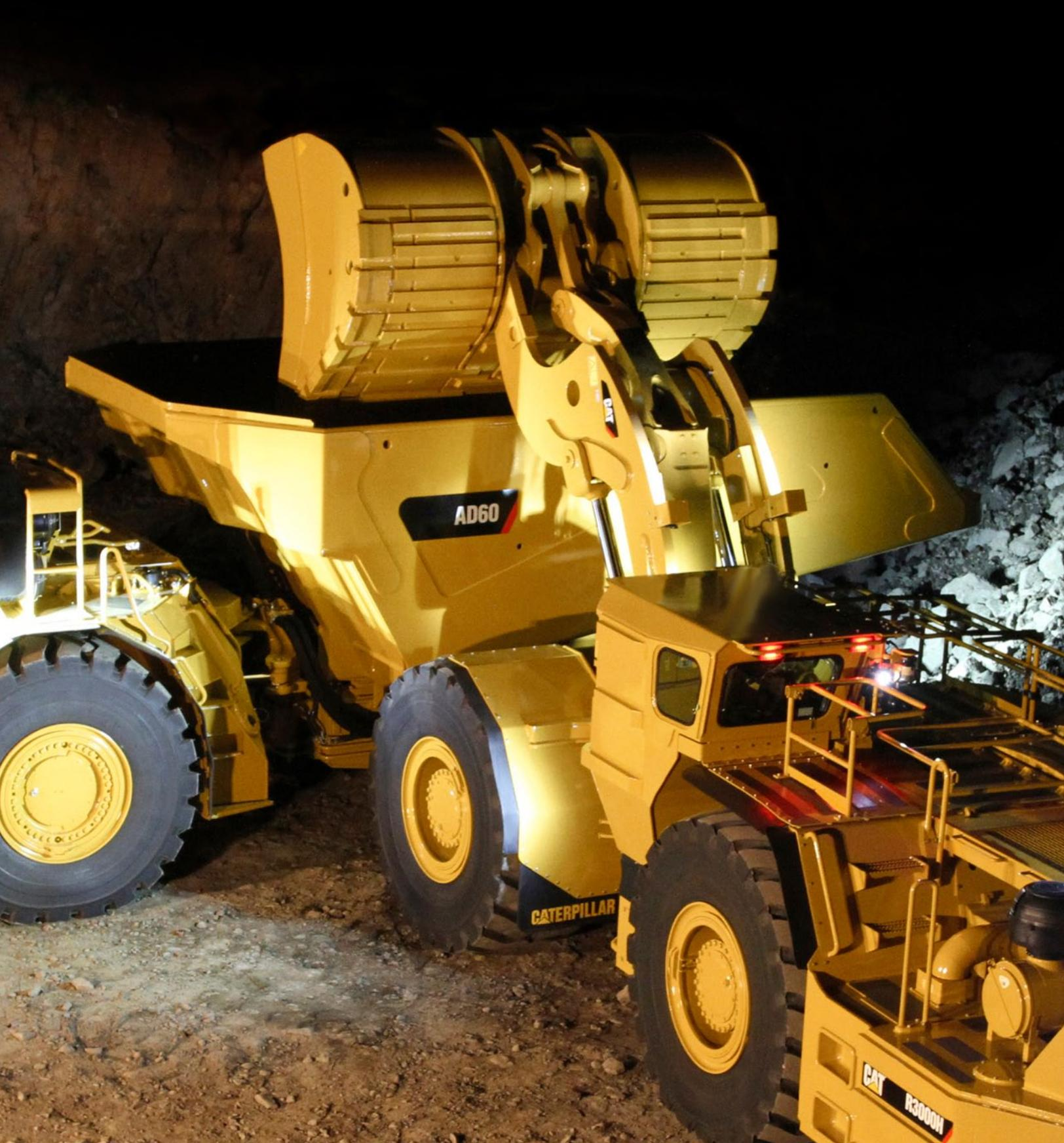
**El Camión Articulado Subterráneo AD60 está diseñado para realizar acarreos de gran volumen y con bajo costo por tonelada en aplicaciones de minería subterránea. Su construcción resistente y la simplificación de mantenimiento garantizan una vida útil prolongada con costos de operación bajos.**
