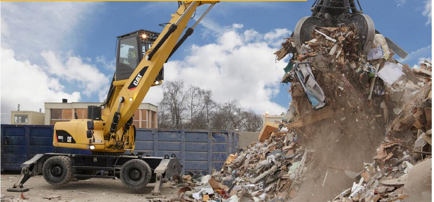
Usted es consciente de que un manipulador de materiales solo trabaja tan adecuadamente como su varillaje delantero es capaz de manejar el trabajo. Las plumas y los brazos del M324D2 MH están diseñados específicamente para las cargas que se experimentan en las aplicaciones de manipulación de materiales. Los brazos están deliberadamente diseñados con placas laterales delanteras para optimizar la protección de las tuberías hidráulicas.
