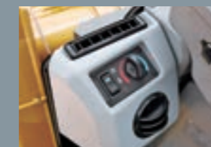
外気導入/内気循環切替機能付エアコン デッシュナ(90202/90302にオプション)
