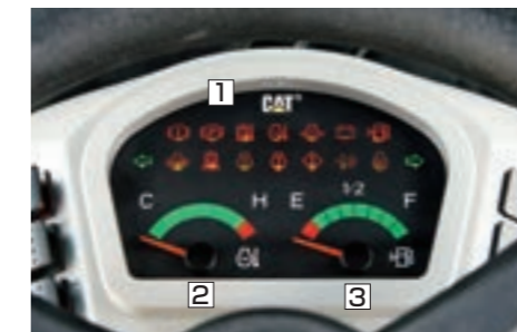
1 各種警告灯 2 冷却水温度計 3 燃料計
