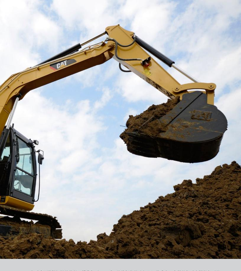
Cat 308E 小型液压挖掘机性能优越,操作舒适,同时还能降低您的油耗和运营成本。宽敞的驾驶室提供舒适的工作区。与座椅为一体的直观操控台便于操作,提高了作业的精准度和效率。标准机尾回转设计包括了一个配重,它安放在机器更靠后的位置。这样可以形成杠杆效果,从而为提升和挖掘作业提供稳定的工作平台。308E 树立了八吨级传统机尾回转挖掘机的典范。
