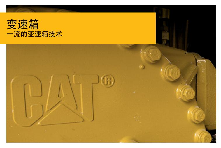
新型 Cat 高密度动力换档(HDPS)变速箱具有九速前进档和双速倒档,采用高级生产率电子控制策略(APECS)和电子化离合器压力控制装置(ECPC,Electronic Clutch Pressure Control),可以实现平稳换档并改进了加速性、提高了生产率。
