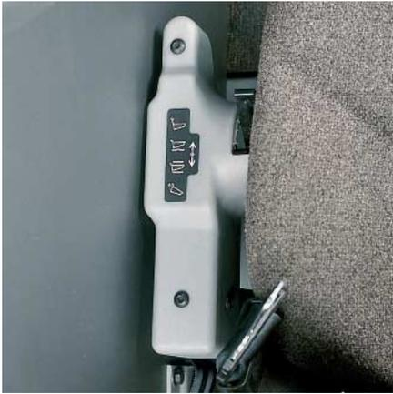
**14) 提升手柄。**指尖控制的四方位电子提升系统，具有车斗降下的缓冲性质，冲击小。安装在近靠操作员座位的位置，便于操作。
