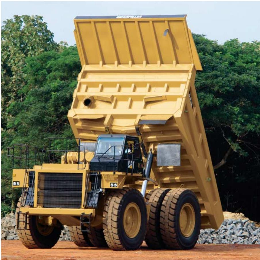
**车斗/底盘整合。**卡特彼勒设计的车斗与统一的车架系统充分匹配，结构可靠，耐用，寿命长。
