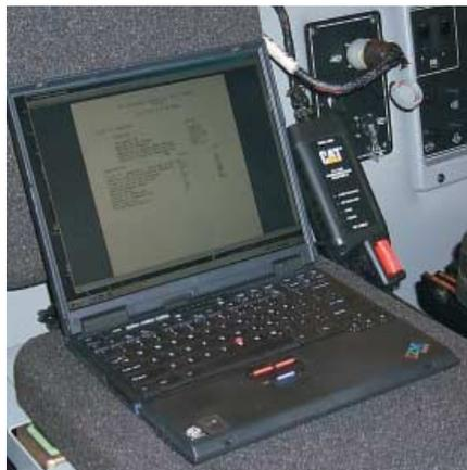
**电子技术员 (ET)。**用卡特彼勒电子技术员维修工具，通过卡特彼勒数据链路，维修技术员容易读取储存的诊断数据，简化故障的诊断并提高机器的完好率。
