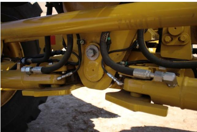
El cilindro de dirección del eje delantero está diseñado para mejorar la durabilidad, y se modificó el trazado de las mangueras hidráulicas para mejorar la fiabilidad.
