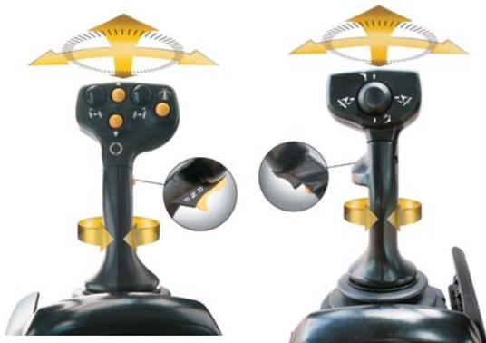
Con el toque de un botón, la característica de articulación de retorno al centro permite regresar automáticamente la máquina a una posición de bastidor en línea recta desde cualquier ángulo.
