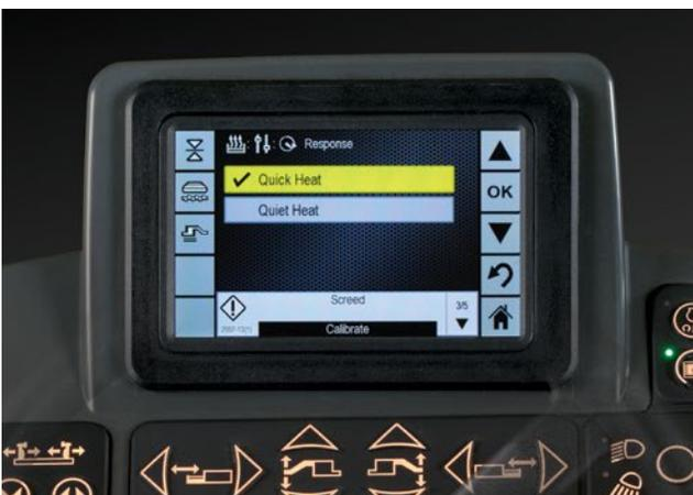
**Einfache Aktivierung der leisen oder schnellen Erwärmung über das LCD-Display. Schnelle Erwärmung ermöglicht Zeiteinsparungen bei der Verwendung von Paketen mit großer Breite.**
