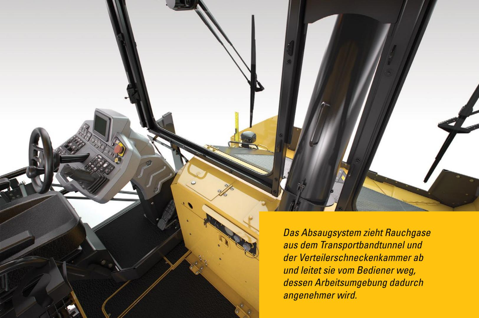
*Das Absaugsystem zieht Rauchgase aus dem Transportbandtunnel und der Verteilerschneckenkammer ab und leitet sie vom Bediener weg, dessen Arbeitsumgebung dadurch angenehmer wird.*
