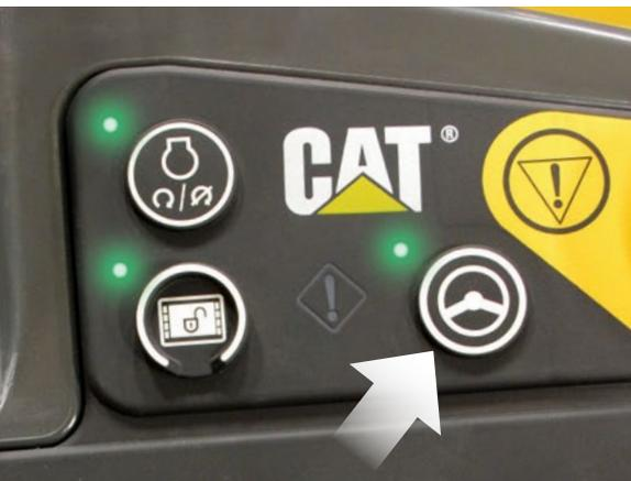
*Maschineneinstellungen werden automatisch zwischen den Bedienständen übertragen; einfach die Taste gedrückt halten, um die Deckenfertigung fortzusetzen.*
