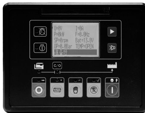
Figura 5.11 - Funcionamento Básico da Tecla Start (Iniciar)
