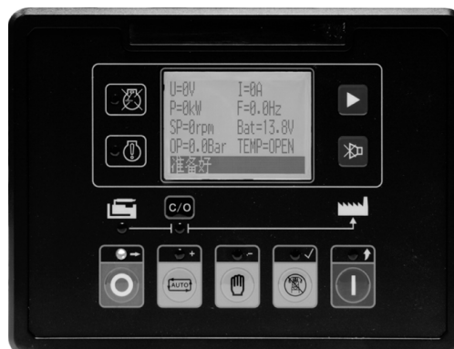
Figura 5.12 - Funcionamento Básico da Tecla Stop (Parar)
