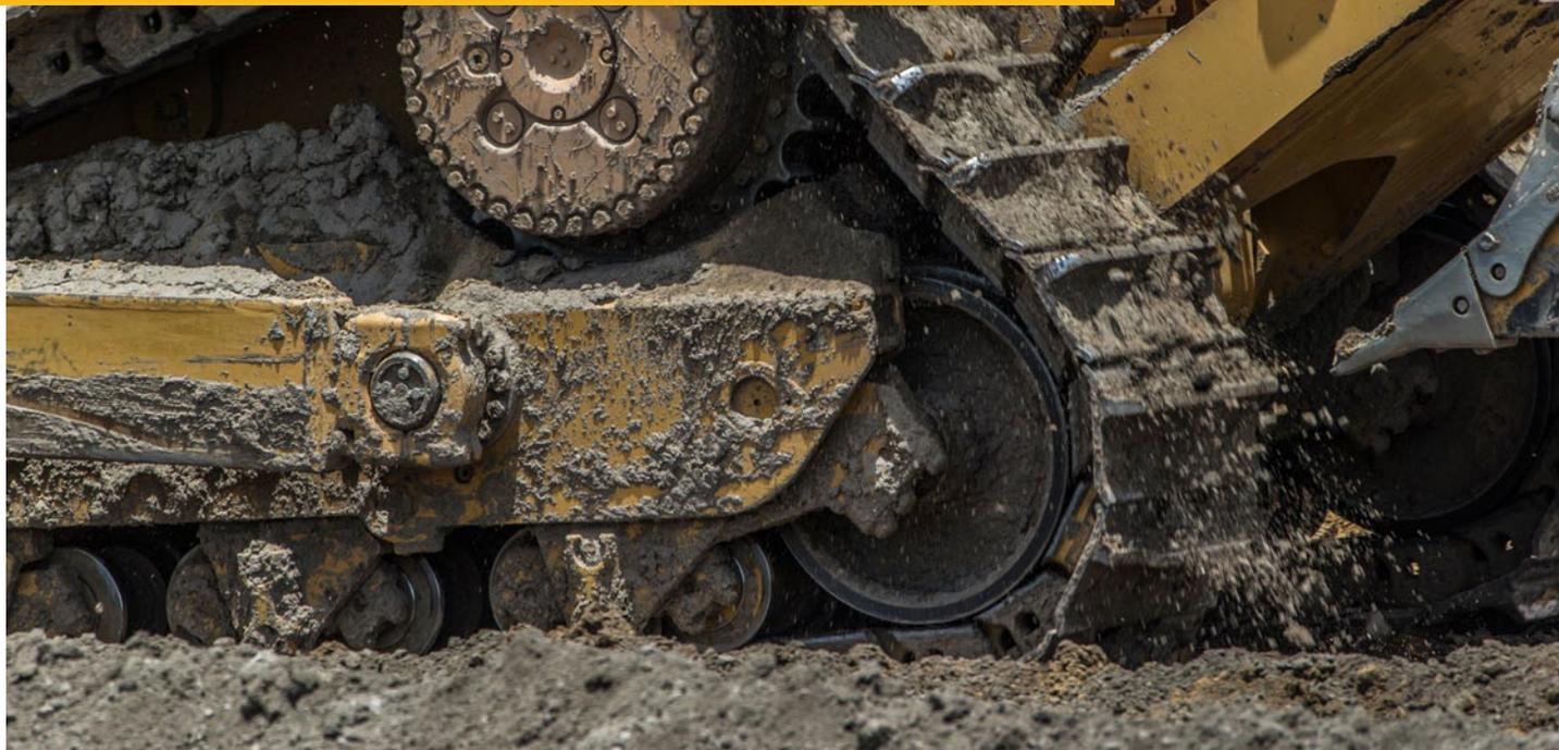
高位置スプロケットとボギーシステムが相まって、強力なけん引力とスムーズな乗り心地を提供します。高位置スプロケットデザインにより、作業機からの衝撃荷重をメインフレームで受け止め、ファイナルドライブやアクスル、ステアリングコンポーネントに強い衝撃が伝わりません。この独自デザインが生産性の向上とコンポーネントの寿命延長に貢献します。
