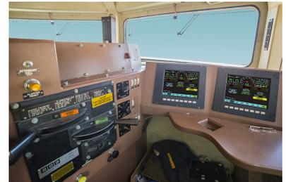
NYAB 的传动管理系统 LEADER 已成为铁路行业的标配，该系统能计算出最省油的运行方式，并提醒员工何时使用油门或制动。作为铁路解决方案 Intellitrain 套件的一部分，EMD 和 NYAB 共同开发了 Intellitrain® PilotAssist，从而将 LEADER 与 EMD 的机车控制系统集成。有了 PilotAssist，LEADER 的油门和动态制动指令可以由 EMD 的机车控制系统自主控制。PilotAssist 与 LEADER 的计算指令同步工作，进一步节省了燃油。
