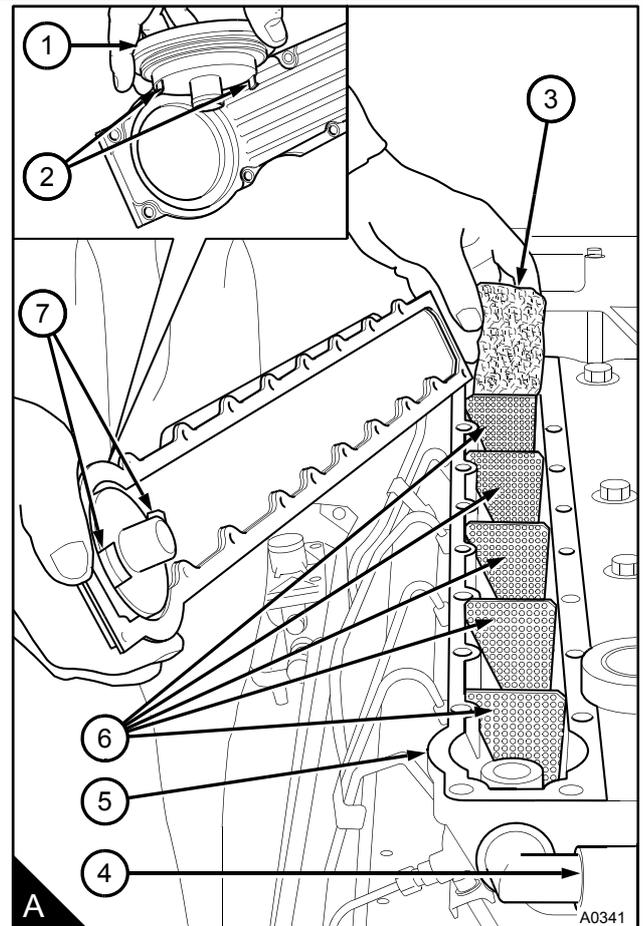
4 Sustituya la junta, que se monta en seco. Coloque el conjunto de la tapa y la válvula en su sitio en el cuerpo del respiradero. Coloque las sujeciones sin apretarlas. Apriete las sujeciones de forma gradual y uniforme a 3 Nm (0,3 kgf m).
