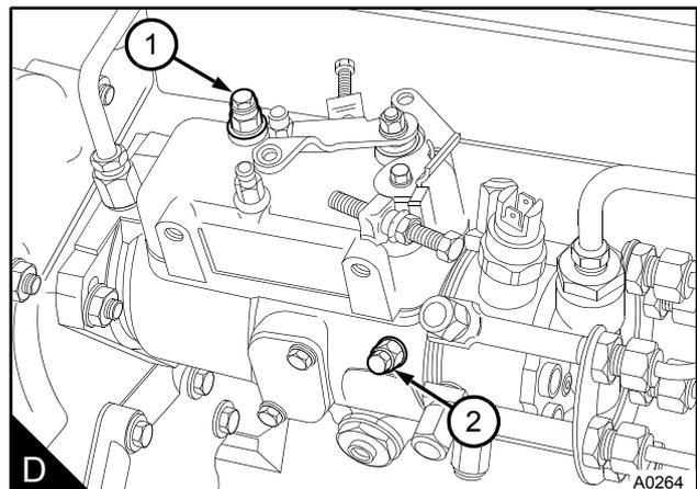
**Atención:** utilice una llave colocada en las partes planas (A1) de la ayuda de arranque con gasoil para inmovilizarlo al aflojar y apretar la tuerca de unión (A2).
