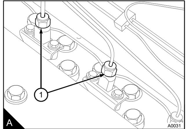
**4** Afloje las tuercas de unión (A1) de las tuberías de alta presión de dos de los inyectores.
