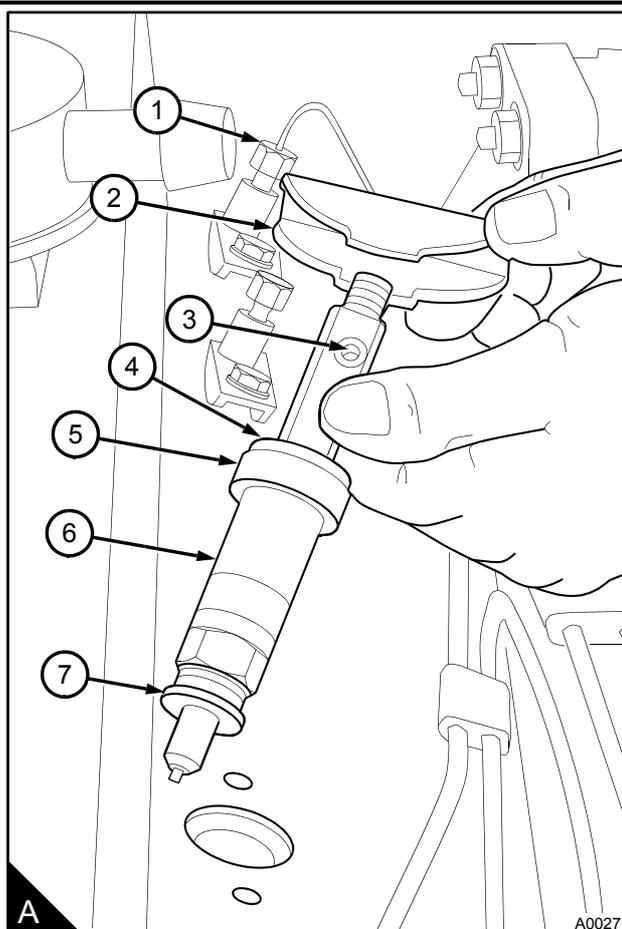
**Atención:** no apriete las tuercas de unión de las tuberías de alta presión a más del par de apriete recomendado. Si hay una fuga por la tuerca de unión, asegúrese de que la tubería esté alineada correctamente con la entrada del inyector. No apriete más la tuerca de unión del inyector, ya que esto puede producir un atascamiento en el extremo de la tubería. Esto puede afectar a la alimentación de combustible.
