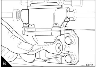
**Nota:** Se o came da bomba de alimentação de combustível estiver no ponto de máxima elevação, não será possível operar a alavanca. Nesta situação, o virabrequim deve ser girado uma volta.
