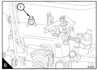
O método de auto-ventilação é usado quando a bomba de injeção de combustível contar com um recurso de auto-ventilação. Essas bombas têm um tubo de ventilação (C1) instalado entre uma conexão em cima da bomba e o tubo de retorno do bico injetor. Os parafusos de ventilação não se prendem a essas bombas. Consulte "Método de auto-ventilação para eliminar o ar do sistema de combustível" na página 37.
