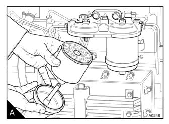
O de tipo cartucho, em que o elemento do filtro tem uma rosca interna (B2) por cima e é preso a um adaptador rosqueado (B1) no cabeçote do filtro (B).
