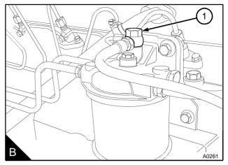
2 Opere a alavanca que fica na bomba de alimentação de combustível (C) até que saia combustível sem ar do parafuso de ventilação do filtro. Aperte o bujão de ventilação ou o parafuso banjo.
