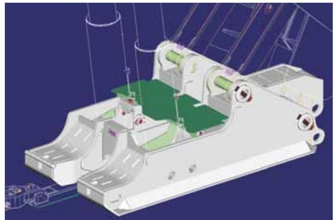
3-координатное проектирование основания секции для мощного пласта
