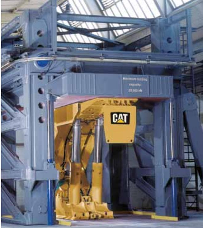
Испытательный стенд для механизированной крепи
