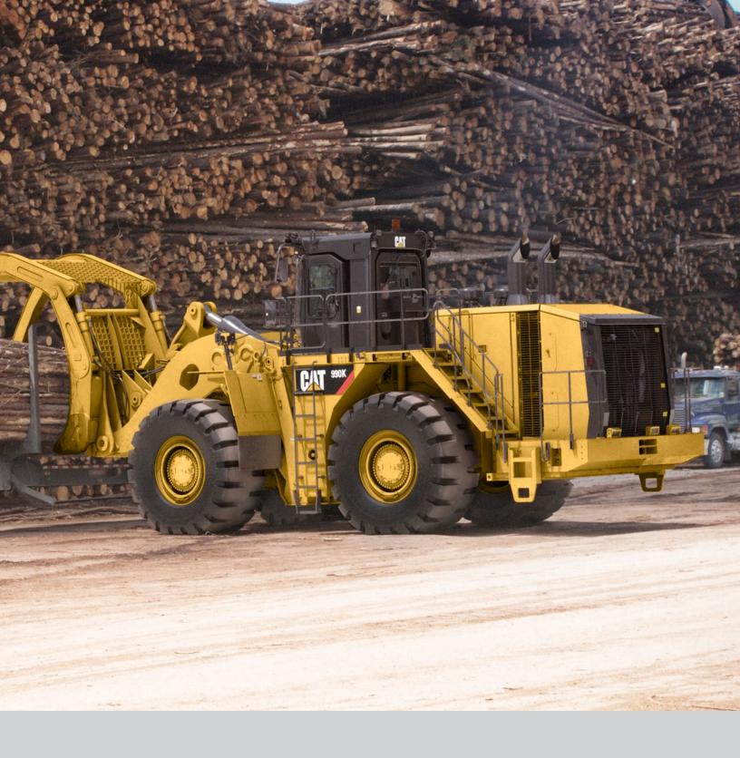
Колесные погрузчики Cat большой мощности отличаются комплексной прочностью, обеспечивающей максимальную техническую готовность на протяжении нескольких сроков службы. Наши машины отличаются улучшенными эксплуатационными характеристиками, простотой технического обслуживания и позволяют эффективно и безопасно перемещать большее количество материала.
