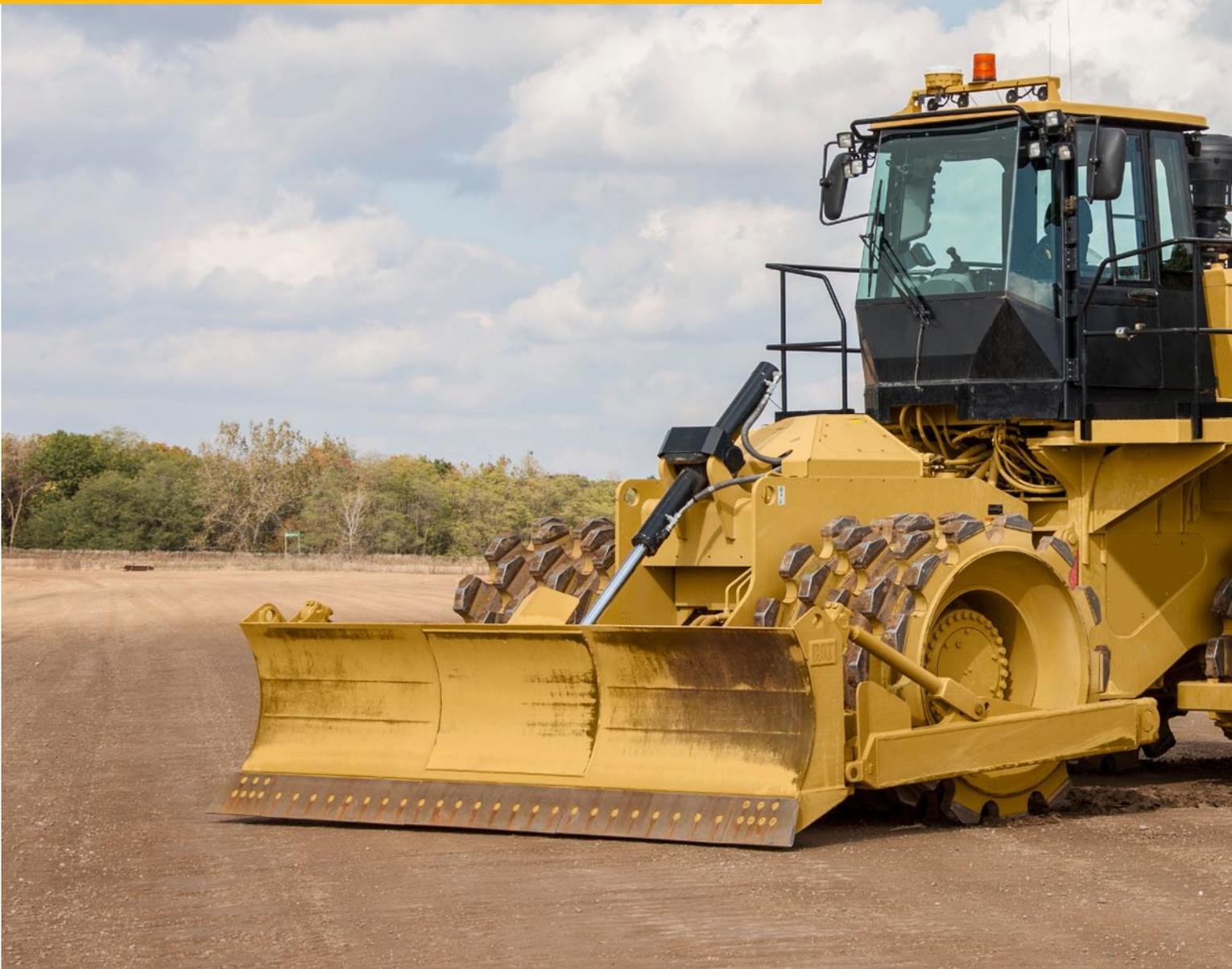
**Nous améliorons en permanence nos produits, dans l'objectif de fournir un environnement de travail sécurisé au conducteur et aux personnes qui travaillent sur le chantier. Le 825K est doté d'une nouvelle échelle pour monter dans la cabine, ainsi que de points d'entretien pratiques.**
