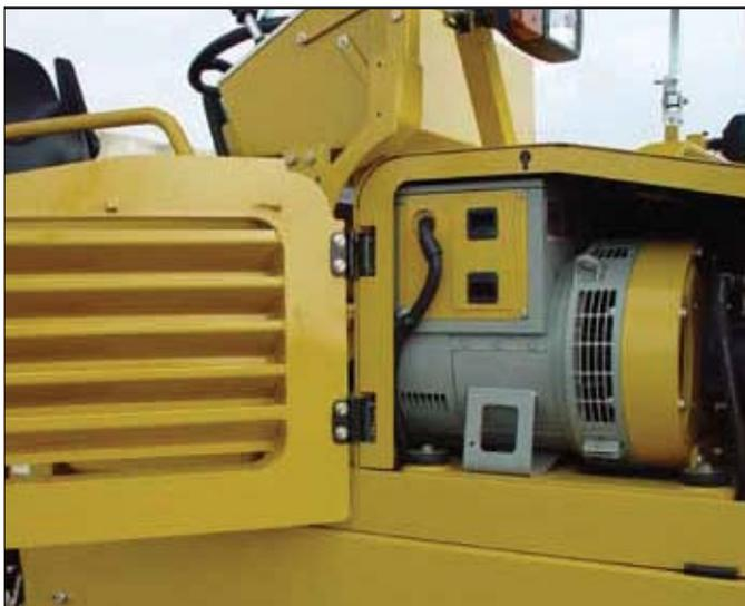
**Однофазный промышленный генератор переменного тока.** Устанавливаемый по заказу бортовой генератор обеспечивает выработку электроэнергии для нагревательных элементов разравнивающего бруса, вспомогательного освещения и рабочего оборудования. Генератор вырабатывает выходную мощность 12 кВт для питания нагревательных элементов вибробруса, напряжение 220 В для системы ночного освещения и 1,5 кВт для электрической системы.
