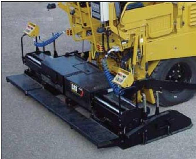
Ширина укладки материала разравнивающим брусом AS3173 составляет 1700-3200 мм.
