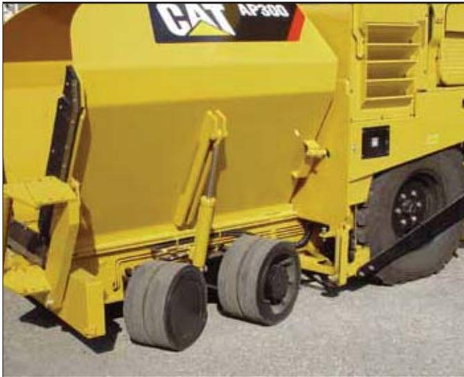
**Колесная машина.** Машина AP300 оснащается двумя ведущими колесами с крупным рисунком протектора шин и четырьмя управляемыми колесами передней тележки. Четыре передних колеса со сплошными шинами установлены на коромыслах переднего моста с независимой подвеской. Такая конструкция обеспечивает максимальный контакт колес с землей и плавность хода по неровностям поверхности.
