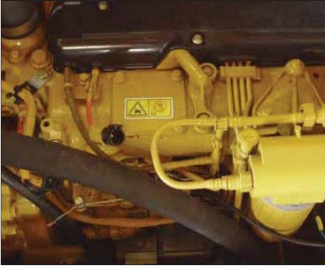
**Двигатель Cat 3054C DINA.** Двигатель 3054C DINA обеспечивает полную мощность 52 кВт (71 л.с.) (по SAE J1995) при 2200 об/мин. Соответствует требованиям европейских норм по выбросам загрязняющих веществ EU Stage II.
