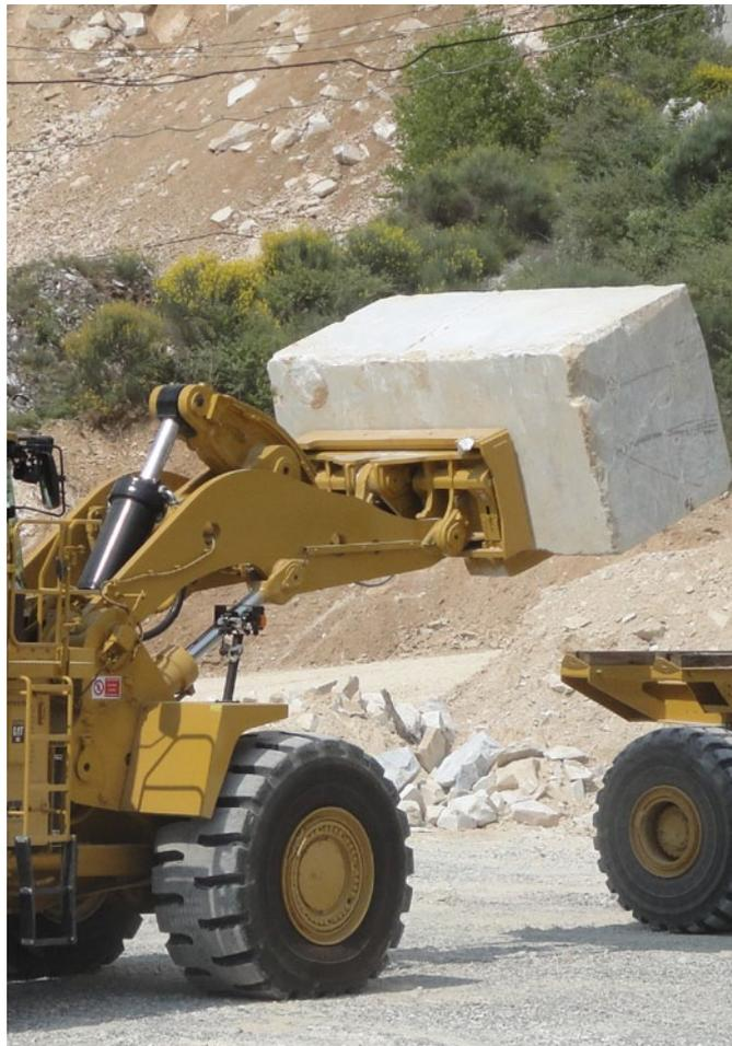
块料搬运作业机具特别为作业要求严苛的采石场及块料搬运市场设计，属于极重负荷型工具。整个系统由一个快速连接器及一系列坚固耐用的工具构成，专门用来搬运和处理大块岩石。这些工具能够适应严苛、恶劣的大块物料处理应用环境，不论在何种大块物料处理应用中，均能助操作员一臂之力。
