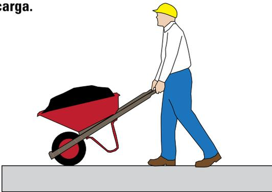
La llanta de la carretilla se desplaza con facilidad sobre concreto liso y rígido.
