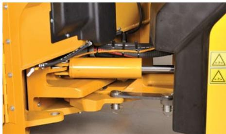
*El diseño de enganche oscilante permite mejorar la calidad de amortiguación en terrenos irregulares.*
