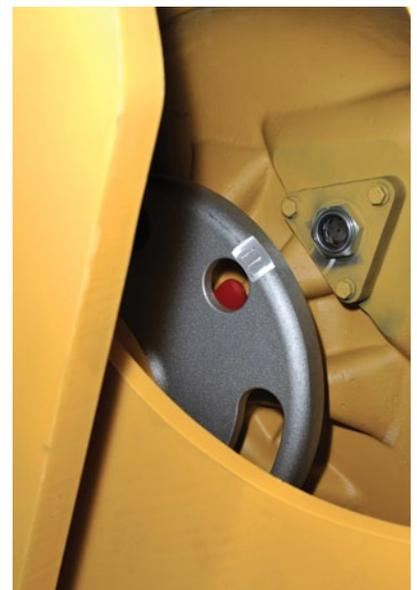
*Configuraciones de amplitud de fácil ajuste para los sistemas de 5 amplitudes y Versa Vibe™*
