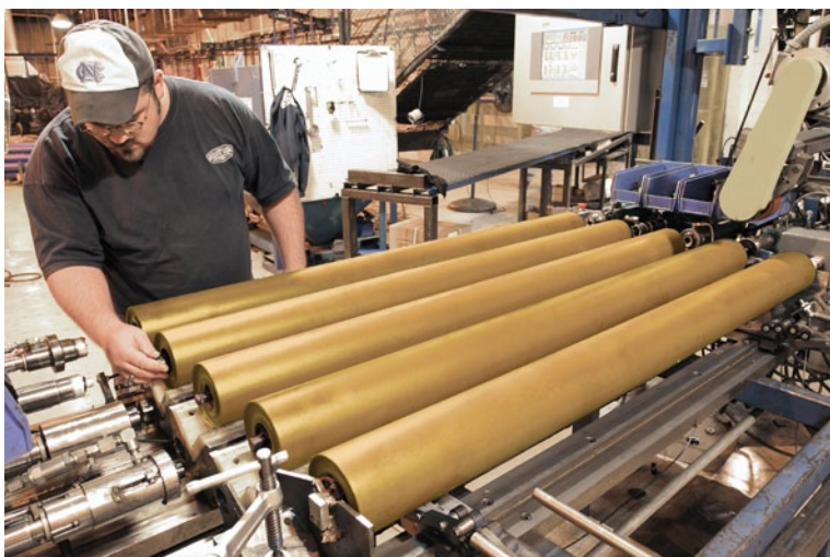
Cat® 钢制托辊需经过五个阶段的自动化装配和测试过程。
