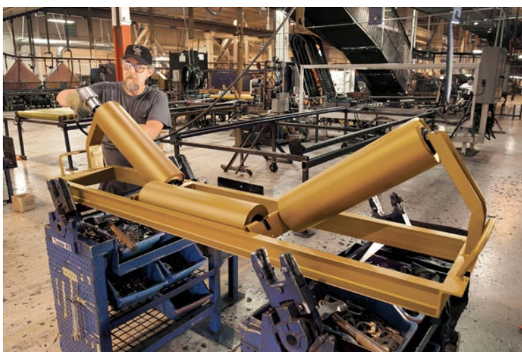
Cat® 钢制托辊需经过五个阶段的自动化装配和测试过程。
