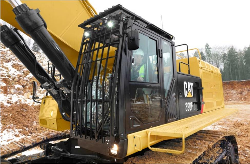
选装的防落物保护结构（FOGS）进一步保护您免受碎屑进入驾驶室造成的影响。
