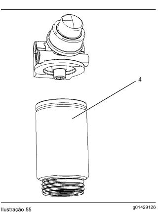
7. Use uma ferramenta adequada para remover o recipiente usado (4).
