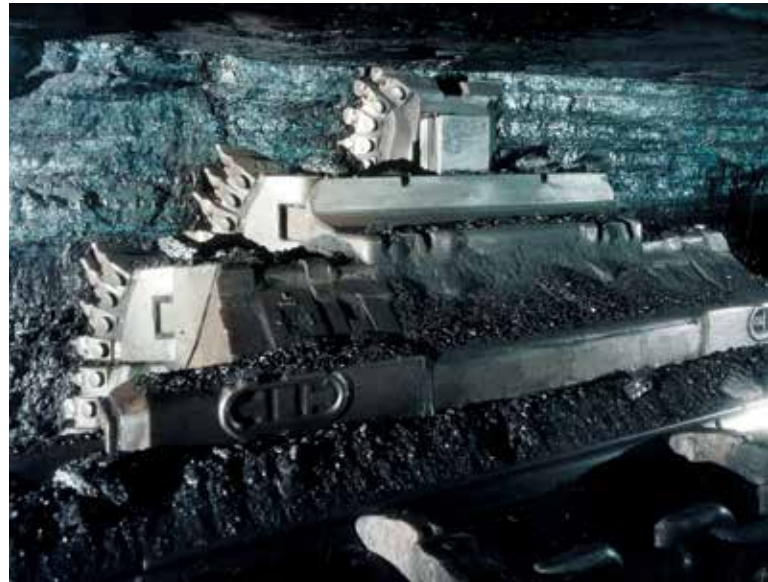
GH1600 滑行刨煤机在硬煤中作业
