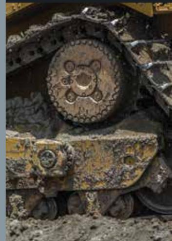
Бульдозеры Cat имеют приподнятую ведущую звездочку и полностью подрессоренную ходовую часть что в сочетании обеспечивает повышение тяги и более плавное движение в дополнение к повышению продуктивности и увеличению срока службы компонентов.
