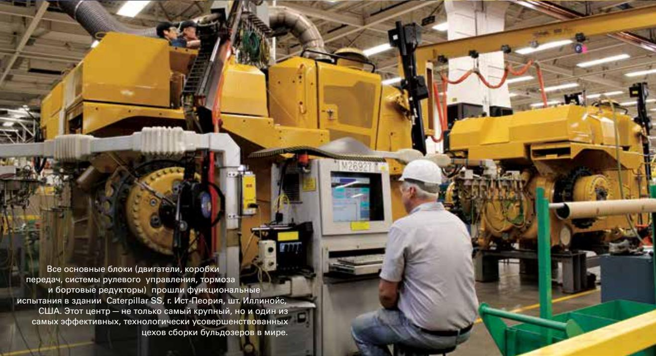
Все основные блоки (двигатели, коробки передач, системы рулевого управления, тормоза и бортовые редукторы) прошли функциональные испытания в здании Caterpillar SS, г. Ист-Пеория, шт. Иллинойс, США. Этот центр — не только самый крупный, но и один из самых эффективных, технологически усовершенствованных цехов сборки бульдозеров в мире.
