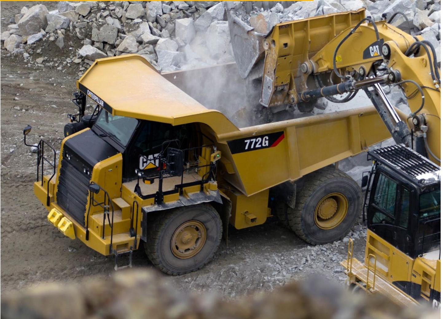
Die Bauweise unserer Mulden dient zur Gewährleistung der Nenn-Nutzlast bei jedem Transport. Da Baustellen immer unterschiedlich sind, bieten wir zwei Muldenbauweisen, optionale Seitenwände für leichte Materialien sowie zwei Auskleidungsoptionen, um Ihre Investition zu schützen und die bestmögliche Lebensdauer zu erreichen.
