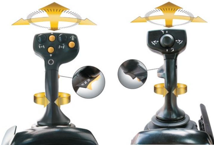
Las dos palancas universales electrohidráulicas permiten a los operadores sentirse más cómodos y ser más productivos. Los operadores tanto nuevos como experimentados de todo el mundo informan que los controles son fáciles de aprender a manejar y que los módulos de control regulables electrónicamente les ayudan a posicionarse para una comodidad y visibilidad óptimas y una operación adecuada.
