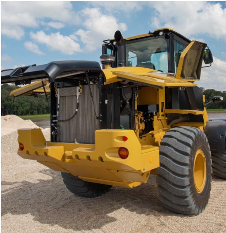
Todos os pontos de manutenção são acessíveis no nível do solo. Três portas de serviço grandes podem ser abertas em qualquer ordem para dar acesso total aos filtros e pontos de manutenção. Intervalos de serviço estendidos reduzem o tempo de serviço e maximizam o tempo de atividade. As características de serviço adicionais incluem:
