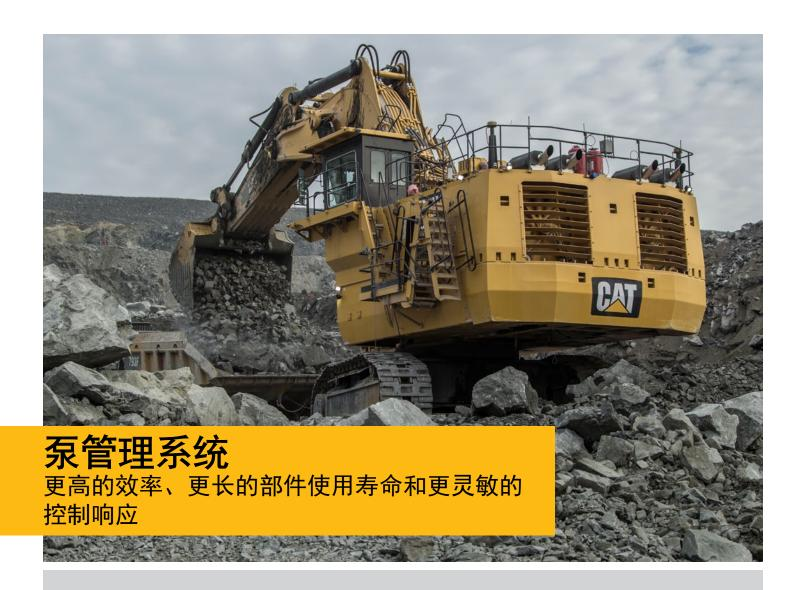
**通过智能泵管理系统,不但可以改善机器操控性和延长部件使用寿命,而且还能降低油耗和噪音** 泵管理系统会持续不断地将实际的发动机及液压系统运行数据与设定值进行对比评估,以此调节泵的输出,从而提供 最佳的性能。这样就能够有效利用发动机,获得更高的生产率。
