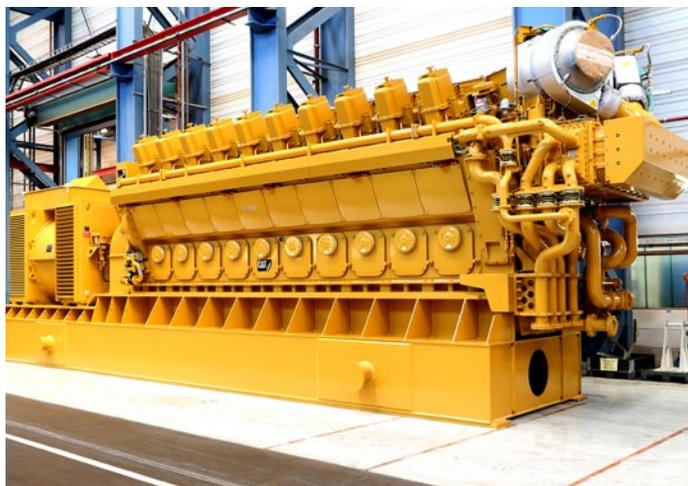
A nova unidade incluirá grupos geradores Cat de 20 cilindros a gás natural, cada um com 12.500 cavalos de força. Cada motor impulsionará um único gerador, e a saída elétrica total da Rubart Station será de aproximadamente 110 megawatts. As 12 unidades podem ser iniciadas e aceleradas rapidamente para atenderem às condições de mercado em constante mudança, para responderem a alterações eólicas e para assegurar total confiabilidade ao sistema da Mid-Kansas.
