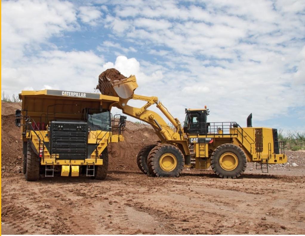
Caterpillar pertama kali memperkenalkan 992 pada tahun 1968. Wheel loader besar ini mampu meraih posisi pemimpin global sejak saat itu, dengan membangun reputasi sebagai loader depan yang aman untuk dioperasikan, produktif, dan tahan lama. Diperkenalkannya Seri K sangat membantu pekerjaan operator serta keselamatan orang yang bekerja di dalam dan di sekitar alat berat.
